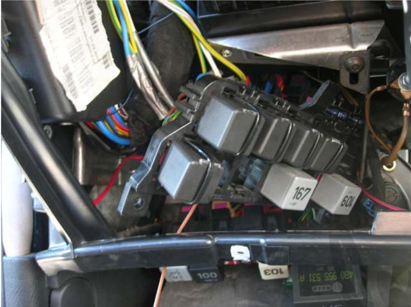
Volvemos a colocar el portarrelés en su sitio sacando los cables que irán al conector por el hueco que queda por encima de los relés... en los seat león, pasadlos por encima del portarrelés trayéndolos hacia fuera. Los cables de la centralita los dejaremos también sobre el portarrelés, pero al lado derecho, justo debajo del módulo confort (en golf IV, leones y toledos) o bien a la derecha del todo del portarrelés, en los huecos libres:
