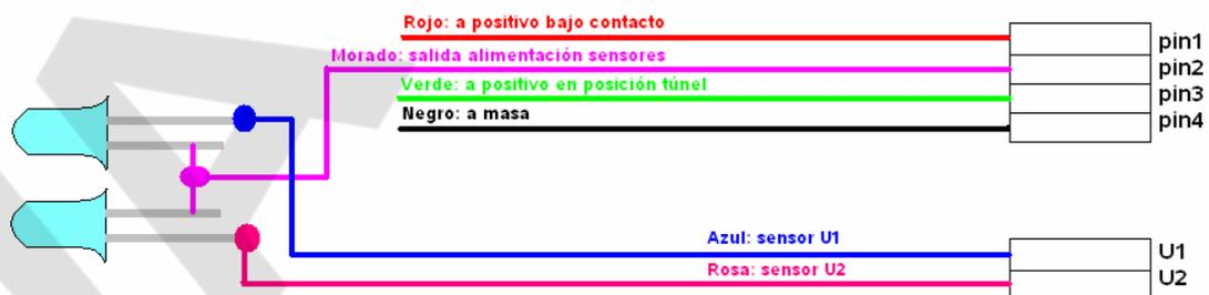
Ilustración 5 - Cableado de alimentación y sensores
