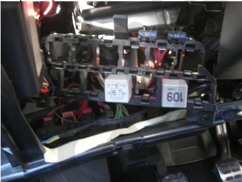
Una vez tenemos suelto el portarrelés, procedemos a colocar los relés que ya tenemos cableados sobre este artefacto... Si no se cuenta con zócalos, podemos sujetar los relés con bridas para que no vibren durante la marcha y queden bien sujetos:
