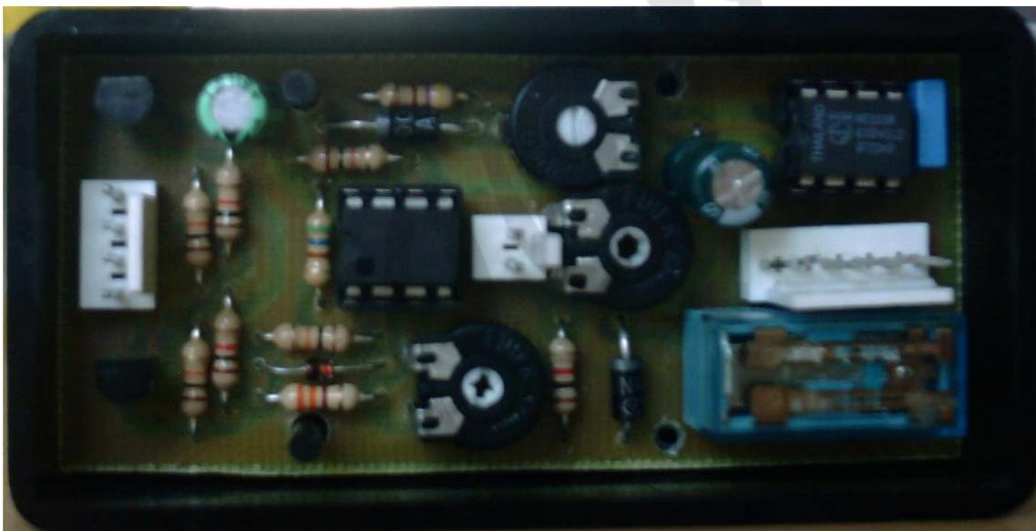
Una vez montados los componentes es mejor probar el circuito antes de llevarlo al coche. Para ello hará falta una fuente de 12 V. Si no disponéis de una, se puede probar también conectando al encendedor del coche. Hace falta preparar el siguiente cableado:
