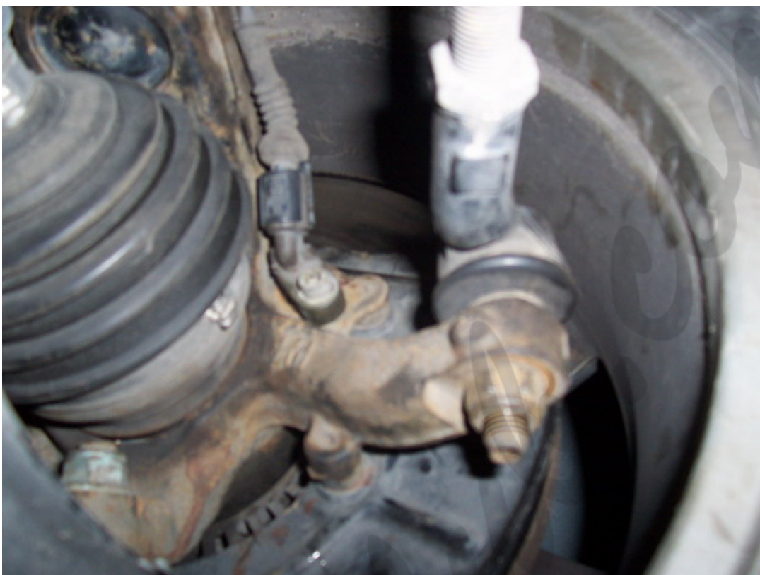
Tuerca de la rótula de dirección... y conector captador ABS
