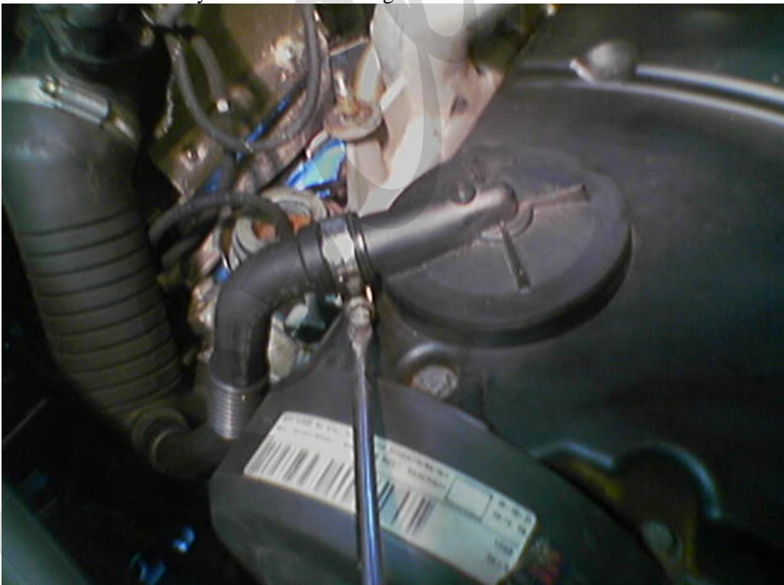
Se sueltas las grapas que sujetan la tapa superior de la correa de distribución para poder acceder a los tornillos de la tapa del árbol de levas.
