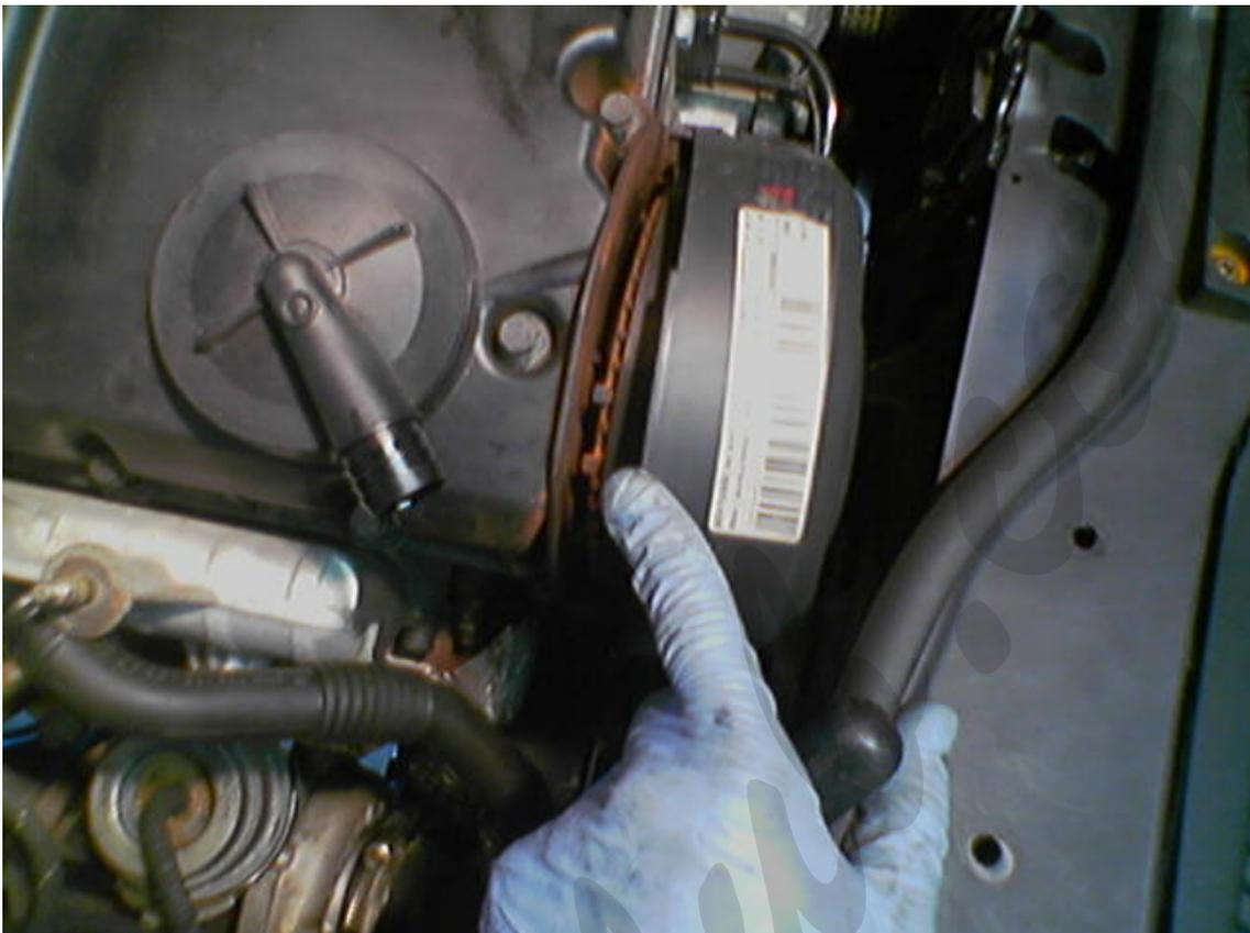
Se sacan todos los tornillos que sujetan la tapa del árbol de levas y se retira a un lado. Esta es la vista general del motor sin la tapa.
