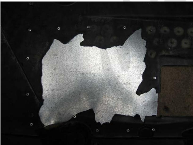
**Rotura tapada con un trozo de plancha galvanizada de 1mm de espesor, y sujeta al plástico con remaches (vista desde la cara de arriba).**
