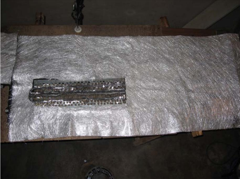
**Quinto:** Embeberemos la fibra en poliuretano (yo he usado 500 ml con 14 ml de activador). Lo extenderemos con el rodillo y usaremos el pincel para moldear los huecos donde van las tuercas que sujetan el bajo (que previamente se han retirado y eliminado las pestañas de plástico que las sujetan).
