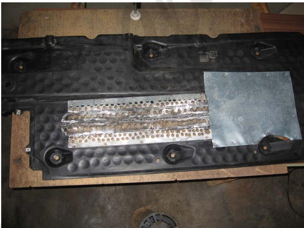
**Tercero: impregnar toda la cara de abajo con una primera imprimación de poliuretano** con el activador adecuado (yo preparé para esta etapa unos 250 ml de poliuretano con 7 ml de activador), extendiendo el poliuretano con el rodillo, y con el pincel en las zonas de difícil acceso.
