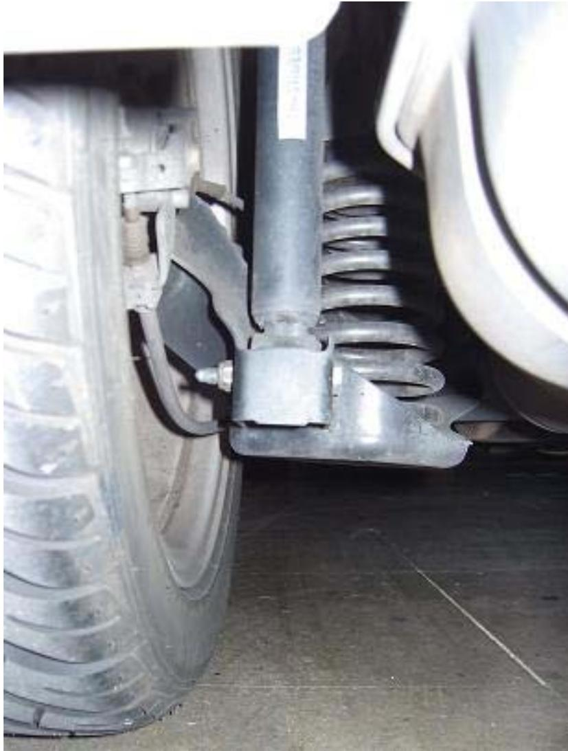
Aquí se ve el muelle, el amortiguador, y el tornillo-tuerca que sujeta la base del amortiguador. A si que a por el gato (Mejor uno hidráulico si lo tenéis), y se levanta el lado que vamos a desmontar, pero no mucho (sin llegar a levantar la rueda del suelo) para facilitar la salida del espárrago del amortiguador.
