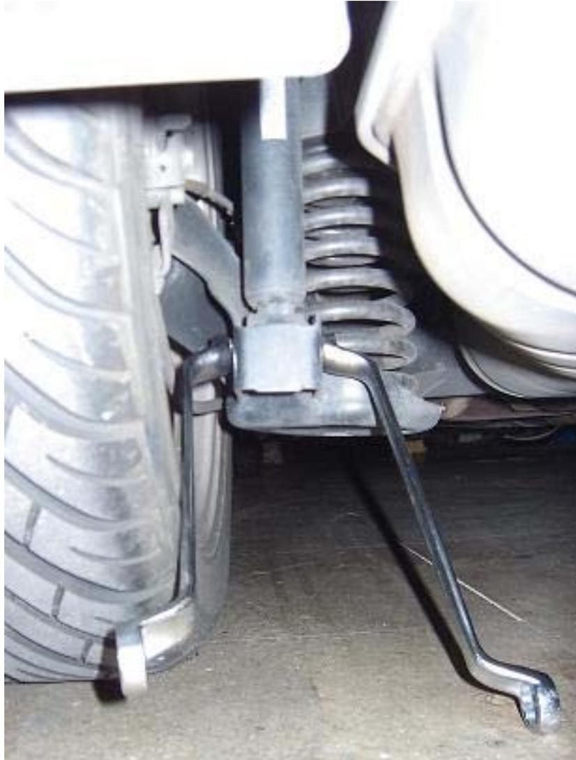
Para aflojar el tornillo, se necesita dos llaves del 16, una con la que fijaremos una de las tuercas, y con la otra (Mejor si es de carraca para agilizar la tarea) para soltar el tornillo. Una vez quitado, se levanta el coche al máximo, ya que hay que bajar la rueda lo mas posible con la mano, y con la otra desacoplar el muelle ahora libre por estar suelto el amortiguador. (mejor se hace entre dos personas).
