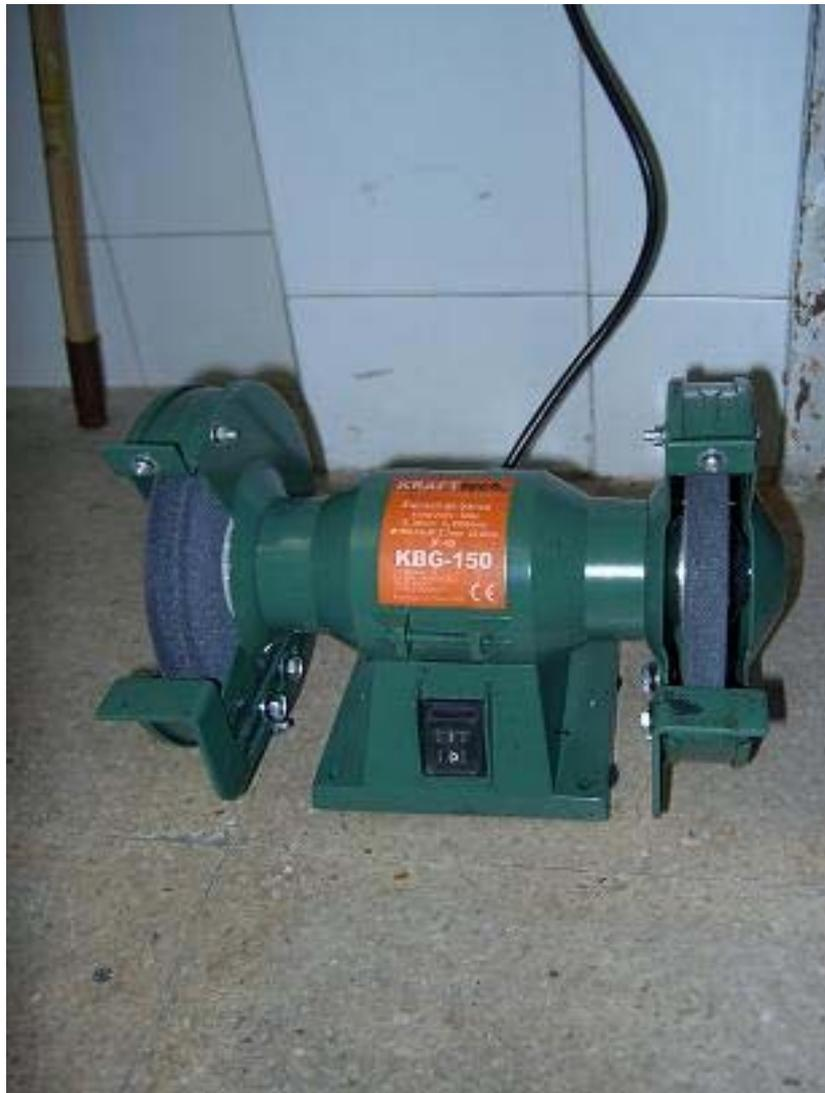
Esta es la amoladora que compré (12 euros en oferta en un gran almacén) rebaja los topes rápidamente y con buen acabado. Se trata de rebajar el tope de caucho unos 0,5 centímetros, hasta llegar a la marca de molde donde empieza el aro metálico interno que da firmeza a la unión con muelle-chasis.
