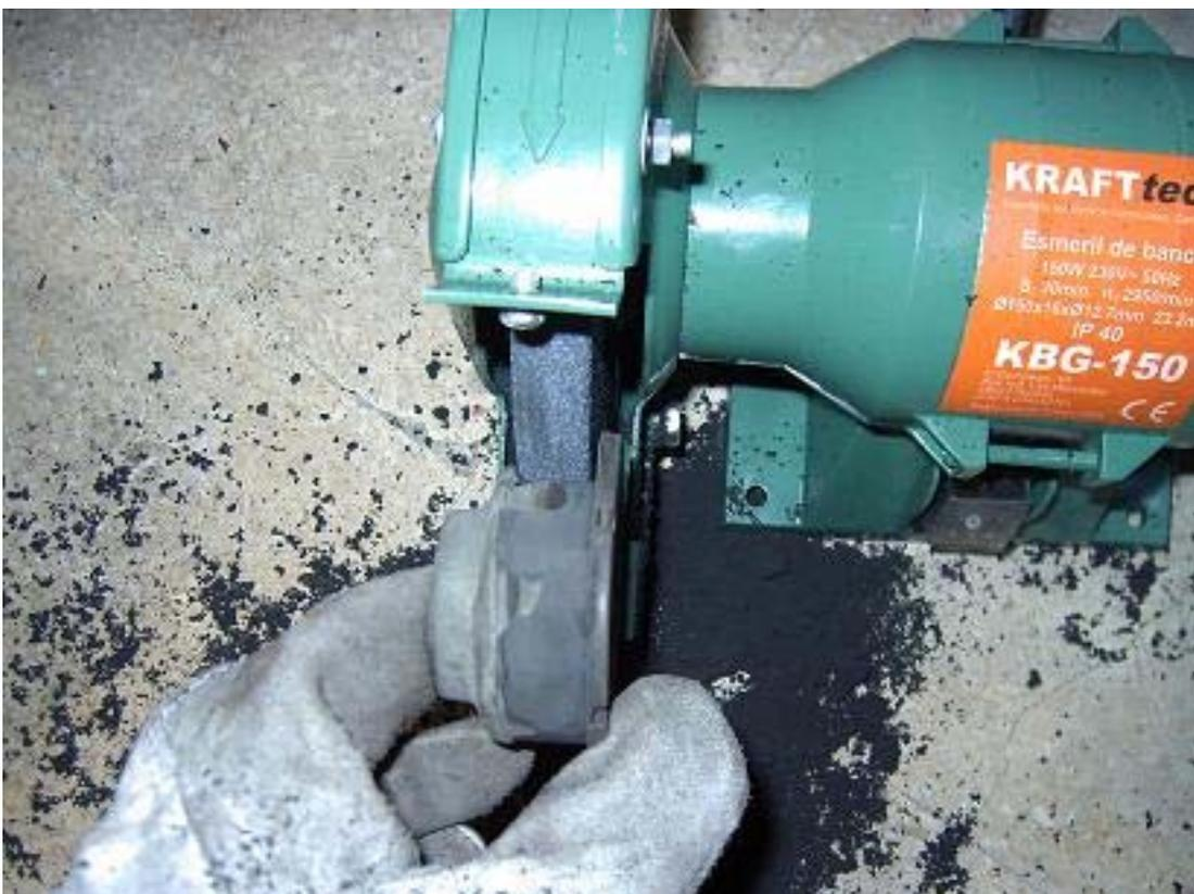
Aquí se puede observar ya casi terminado, luego, una vez comprobado el nivel y la igualdad del mismo en todo el perímetro, le afinamos un poco en el rodillo mas fino.
