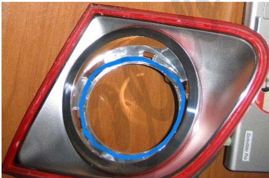
Antes de cerrar el faro, se comprueba que funcionan todos los led, utilizando algún sistema de alimentación, un transformador 12V, etc. Un ejemplo rápido sería una pila de 9V. Sólo es para verificar que se iluminan todos.
