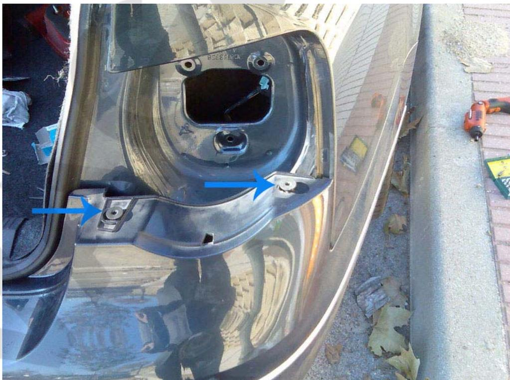
Para desmontar el panel interior derecho del maletero hay que quitar 2 tornillos torx que van sujetos en la chapa, junto a la rueda de repuesto y 2 tetones que están en la parte superior, el anclaje metálico para los pulpos que está al fondo y el otro anclaje de plástico que está justo en el borde del maletero. Se puede apreciar en la ilustración que también llevan grapas.
