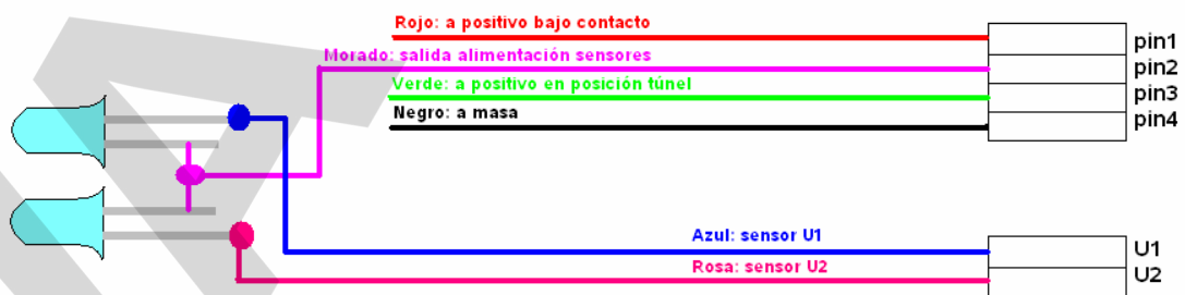
Ilustración 2 - Cableado de alimentación y sensores
