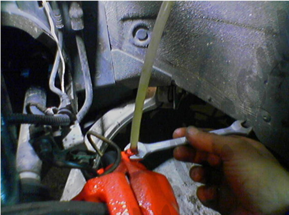
Si no disponéis de alguien que os ayude también se puede hacer con una jeringuilla colocándola en el extremo del tubo y chupando el líquido. Es algo más lento pero igual de eficaz. Este sistema no sirve para el bombín del freno ya que tiene internamente otra distribución y no sirve.
