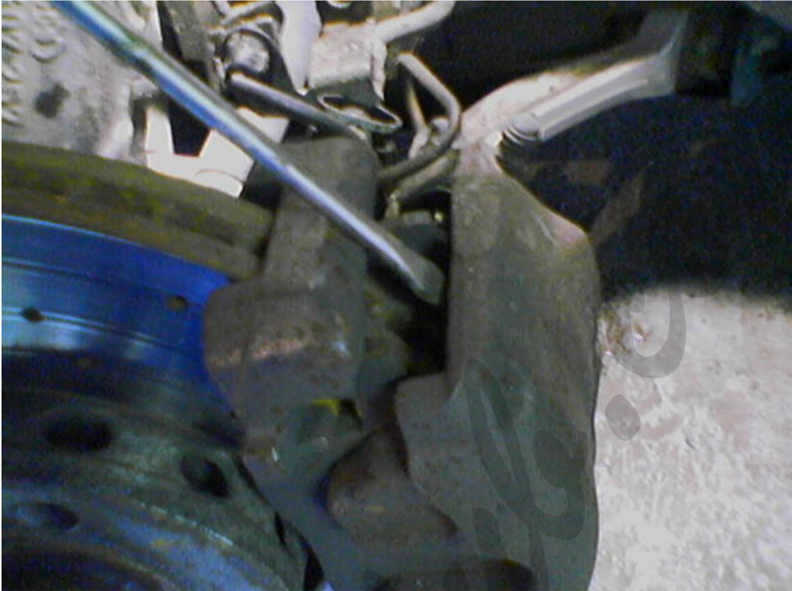
Con ayuda de una prensa para pinzas de freno o con un sargento de carpintero empujáis el pistón de la pinza hasta que haga tope.
