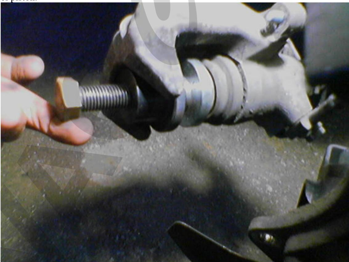
Una vez que hayamos terminado pondremos el disco nuevo si lo habéis cambiado, las pastillas nuevas, y colocáis la pinta en su sitio apretando los tornillos de la misma forma que los aflojasteis, sujetando la tuerca intermedia.
