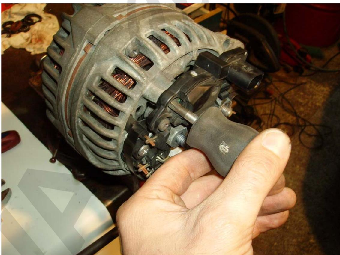
Ya lo tenemos fuera. Como aun le queda bastante escobilla lo volvemos a meter en el sitio. Si fuera necesario cambiarlo hay que apuntar la referencia que trae impresa y se pide exactamente el mismo. Se coloca en el sitio y se monta tal y como hicimos el desmontaje.
