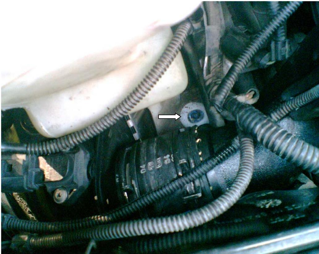
Cuando las tengamos fuera quitamos los conectores del bote y lo sacamos para fuera, con cuidado de no doblar demasiado las tuberías por donde circula el líquido. Yo solo desenchufé los conectores eléctricos de los laterales sin sacar la tubería para que no se saliera el líquido.
