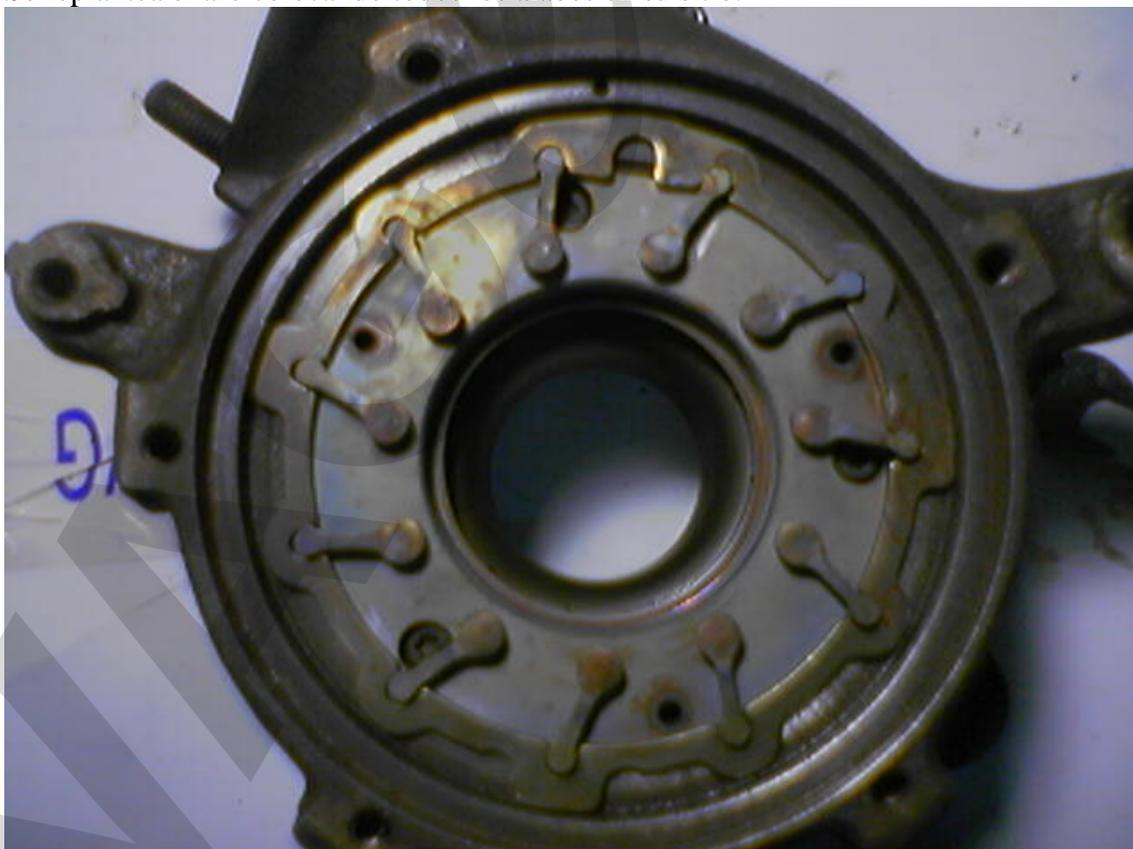
Se verifica que quede el aro en la misma posición que antes haciendo coincidir en este caso en rebaje por el punto que hay en la caracola. Con ayuda de un destornillador plano pequeño se levanta un poco el aro para abocar los 3 rodillos y sus pasadores.
