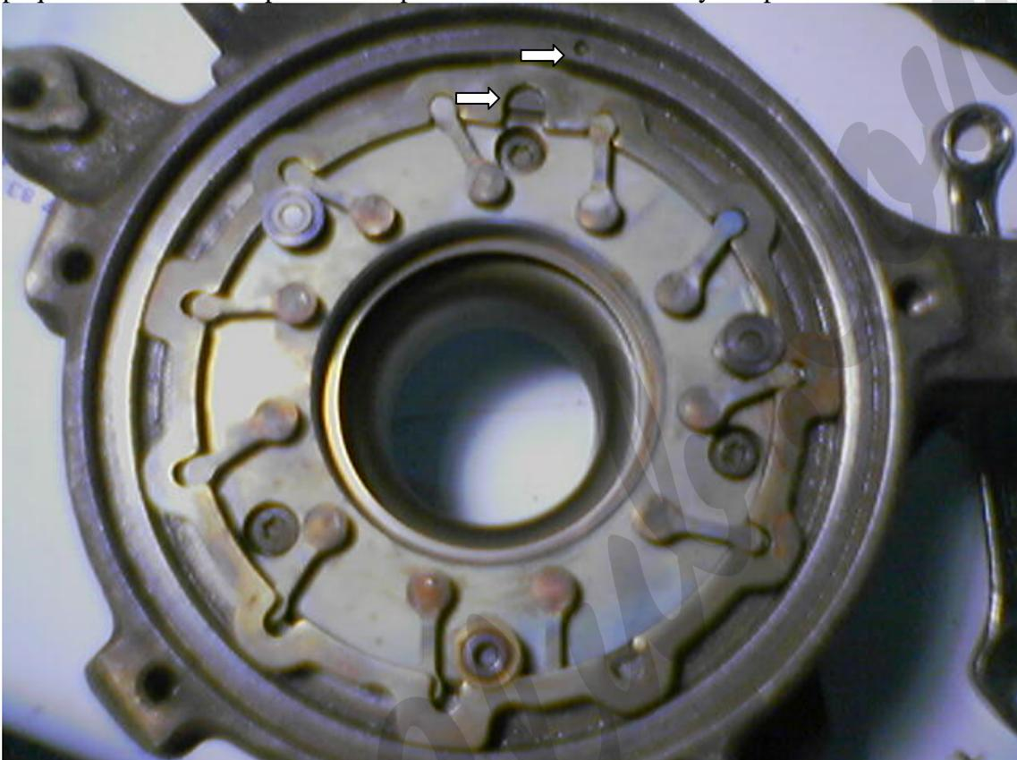
Es importante que nos quede bien colocado el aro porque sino no va a coincidir luego y tendremos que desmontar. Se coloca la otra parte y se comprueba que hace el juego bien. Se colocan todos los tornillos previamente limpiados por un cepillo de alambres para eliminar el oxido o carbonilla del mismo.
