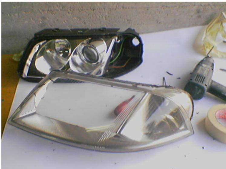
Con muchísima paciencia y sin hacer el “burro” se va despegando todo el cristal. No hace falta hacer demasiada palanca solo hay que esperar hasta que la propia silicona vaya rompiendo sola por la presión de los destornilladores y por el que vais metiendo por la parte de dentro de la silicona.
