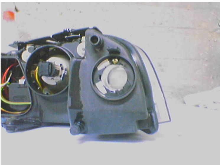
Pasamos varias veces el cutter por el surco que hay entre el cristal y su base para cortar la silicona que une las dos piezas. No cargar demasiado porque podéis cortar la parte negra y eso no es interesante. Con pasarlo 4 o 5 veces debería ser suficiente.
