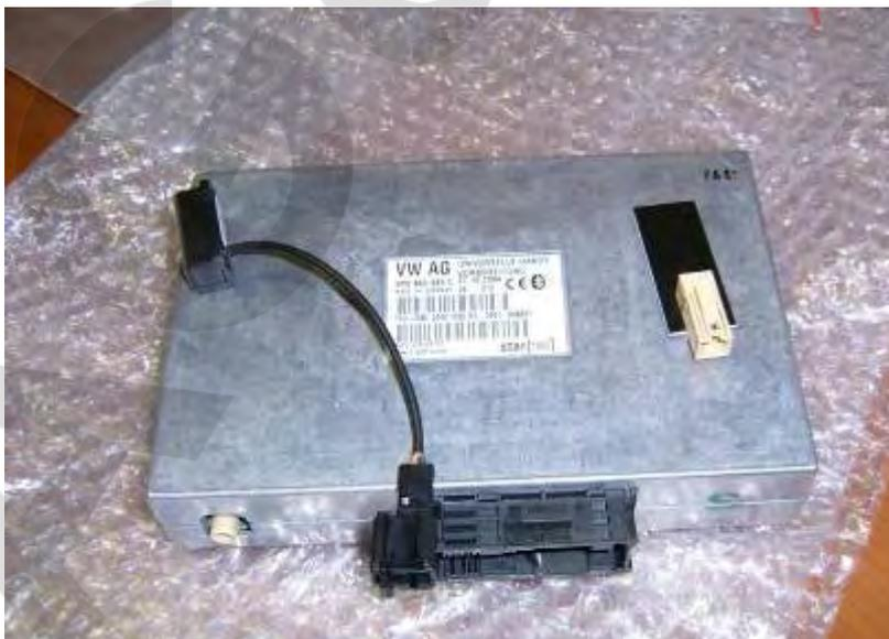
Debemos sustituir la centralita existente 5P0 862 335, por la nueva, y codificar adecuadamente.
