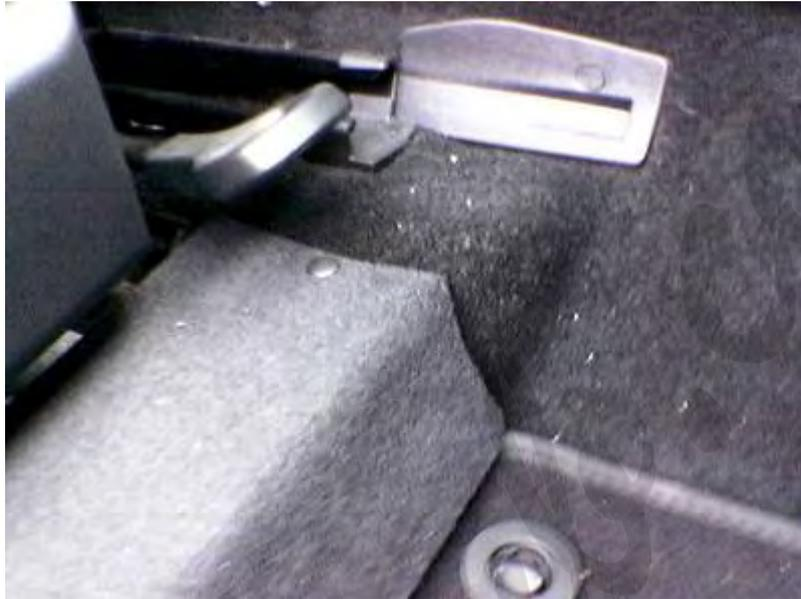
Desplazando el asiento a su posición más lejana, conseguiremos acceder sin problemas, al punto de instalación. El chasis está sujeto por dos tornillos metálicos, que se retiran mediante torx o llave de 10. Es mejor retirar el chasis mediante esos dos tornillos, que tratar de tirar de la centralita existente.
