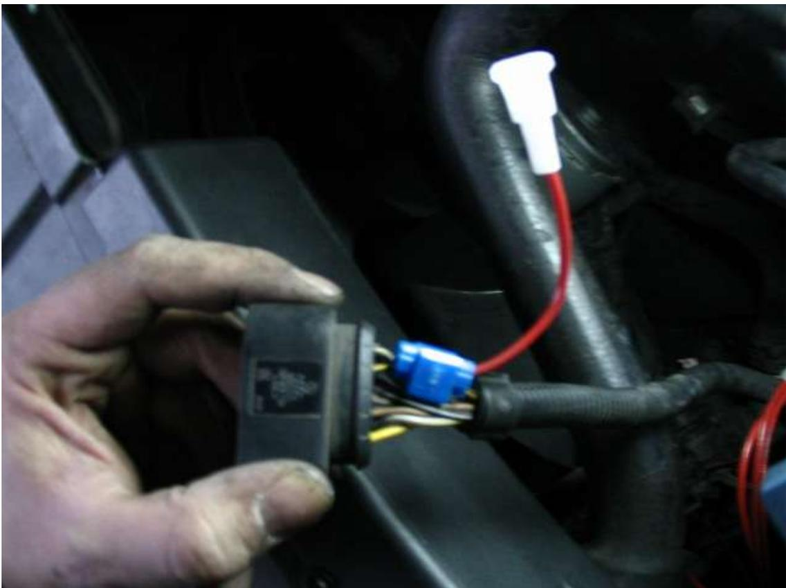
Ahora pasamos los cables que van al interruptor del salpicadero, y lo haremos a través del pasamuros por el que va el mazo de cables que vienen del vano motor, pasando una guía hecha con un alambre duro desde la parte interior del coche al vano motor, le encintamos los dos cables y tiramos de la guía. En la foto vemos donde esta ubicado este pasamuros y vemos los dos cables ya pasados
