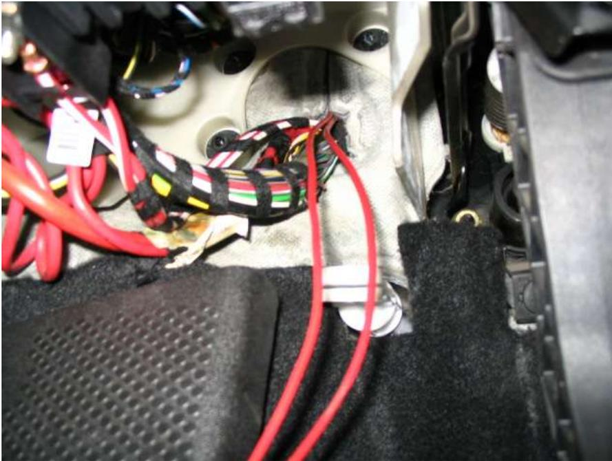
Estos dos cables los vamos embridando hasta el lugar donde colocaremos el interruptor, en este caso, he escogido una de las tapas ciegas que hay debajo de la salida de aire central. Como se puede ver en la foto, también esta el cable de masa que sirve para las luces del interruptor y que cogemos de cualquier parte metálica y el cable que nos da los 12v para el piloto rojo del interruptor. Para poder desenchufar el interruptor, he colocado un conector Molex
