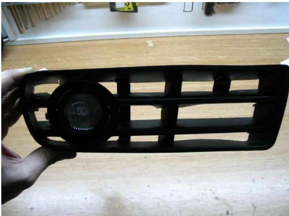
Una vez montados los focos en las rejillas, procederemos a la conexión eléctrica. Conectamos los faston, aislando el positivo con el trozo de tubo que viene con los focos, y colocando la tapa trasera de goma que protege de la humedad y la suciedad
