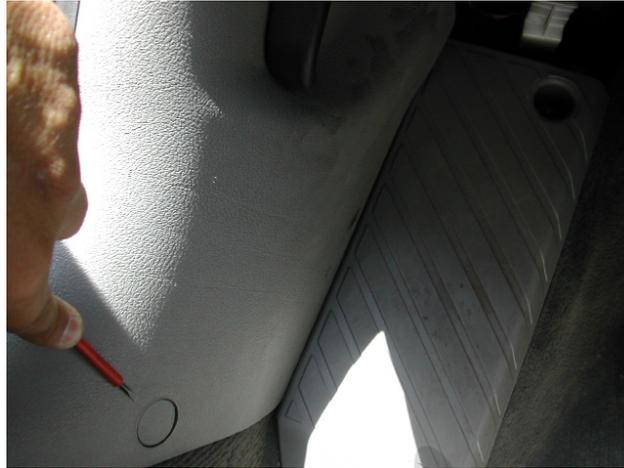
Con la guía pasacables, la metemos por el hueco hasta que salga por el vano de la puerta y pasamos el cable por ahí, nos saldrá por entre los cables ocultos por la tapa retirada:
