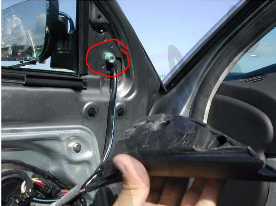
El mazo de cables del nuevo espejo tiene muchos más cables que el original:
