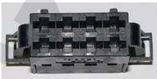
Ojo este conector hembra (B) posee dos aberturas laterales para poder insertar los pines, abrirlas antes y fijaros bien en los números que tienen serigrafiados al colocar los cables. Una vez conectados todos los cables enchufamos el conector negro hembra con el otro conector negro macho (A) que va cableado al relé.
