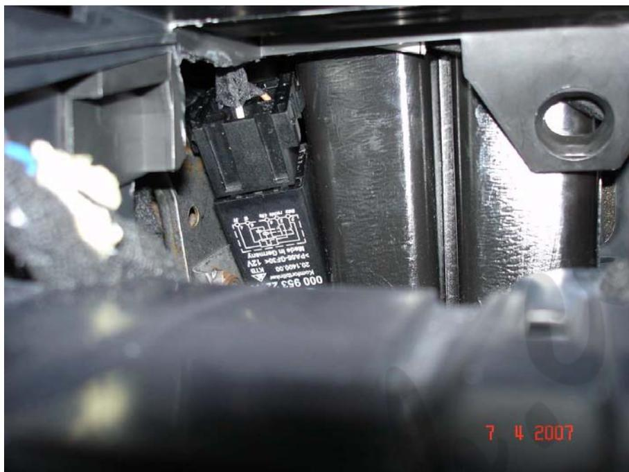
Para montar se sigue el proceso de desmontaje a la inversa y creo que no tendréis problemas. Lo que si debéis es buscar un hueco para el nuevo relé que va a llevar vuestro vehículo. Asegurarlo bien para que no se mueva y no tengáis ruidos al circular. Procurar no pillar ningún cable a la hora del montaje del salpicadero.
