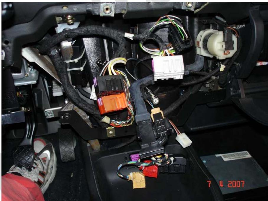
*Si sois curiosos podéis observar en esta foto que el relé lo amarré junto al montante metálico de la izquierda. Craso error ya que luego al montar el salpicadero chocaba con este y tuve que cortar y ponerlo más abajo ver foto.*
