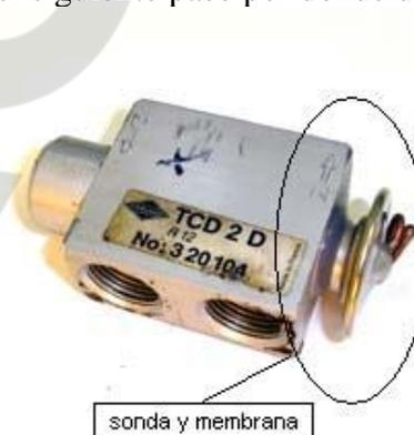
Se trata de una válvula que mediante una sonda instalada encima de ella (la membrana de la foto) regula el paso de refrigerante al **evaporador**.
