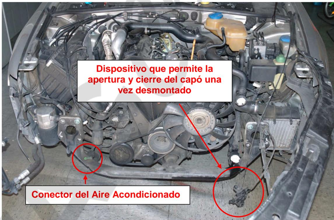
**Proc. 1 - Sustitución únicamente de la correa del A/A y/o del tensor correspondiente.**
