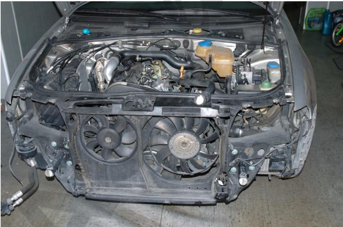
Para desmontar los absorbedores de impacto tendremos que quitar los 4 tornillos que lleva en cada uno de los lados mediante la ayuda de una llave torx nº 45, así como otro tornillo de cabeza hexagonal del nº 10 que se encarga de posicionar el absorbedor en su sitio correcto.
