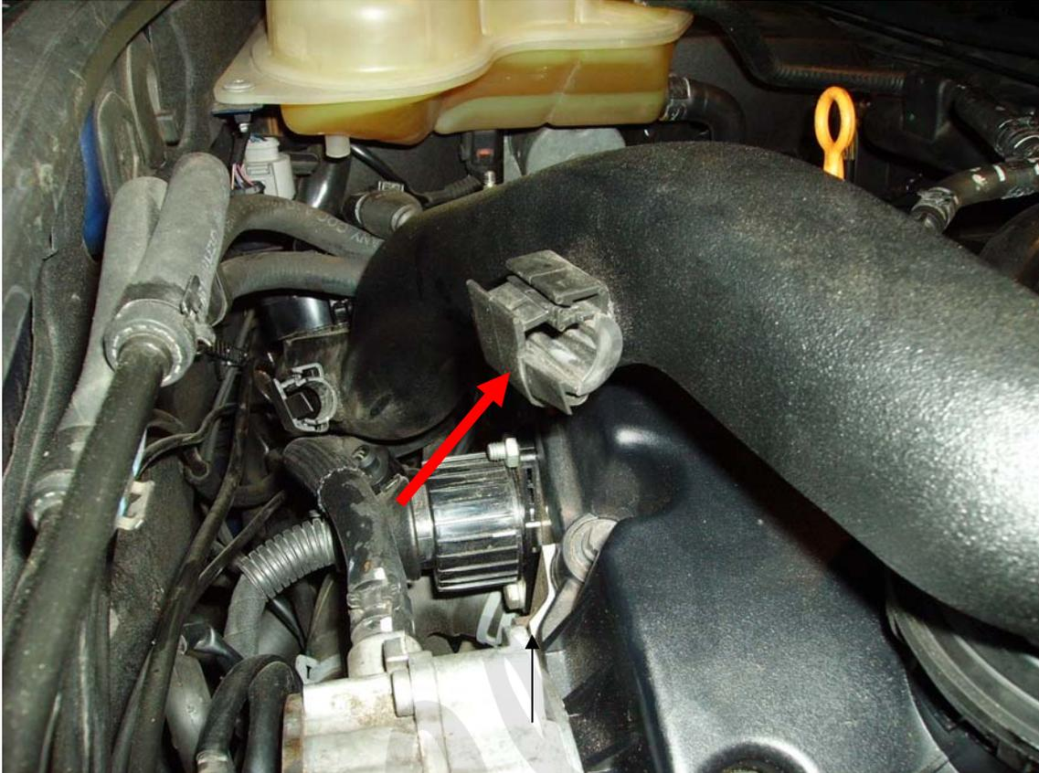
Sacamos los tornillos que sujetan la electro válvula que gobierna la EGR. Por detrás hay que sujetar las tuercas para poder sacar los tornillos.
