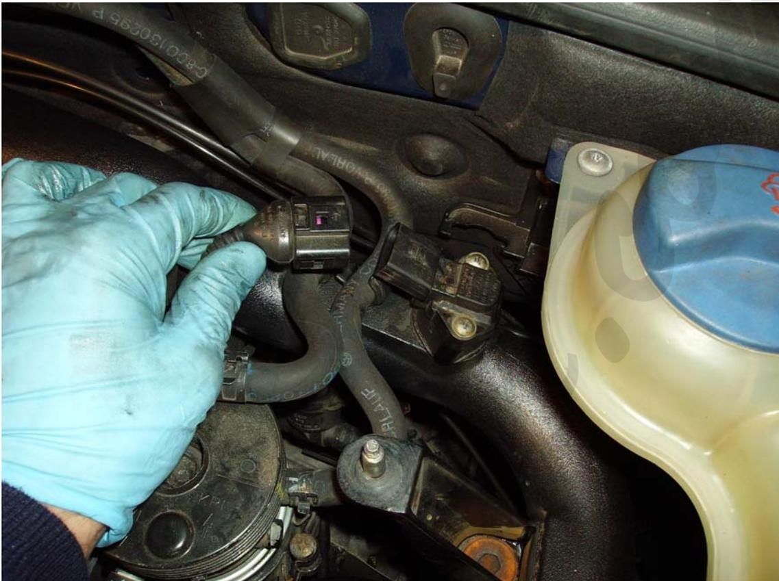
Aflojamos la abrazadera del tubo que va del intercooler a la admisión.
