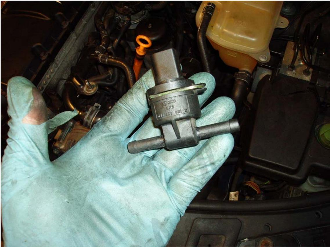
Ya que hay que deshacer todo pues de paso aproveché para cambiar también la válvula antiretorno que va justo después del sensor. Este se encarga de que siempre tenga gasoil la bomba tándem y también puede ser la culpable de cabeceos en el motor ya que la tándem no mantiene una presión interna. Se saca y se comprueba que hacia un lado pasa aire y que al otro tapona perfectamente (la tenía bien). Aquí tenéis la válvula antiretorno y donde va alojada.
