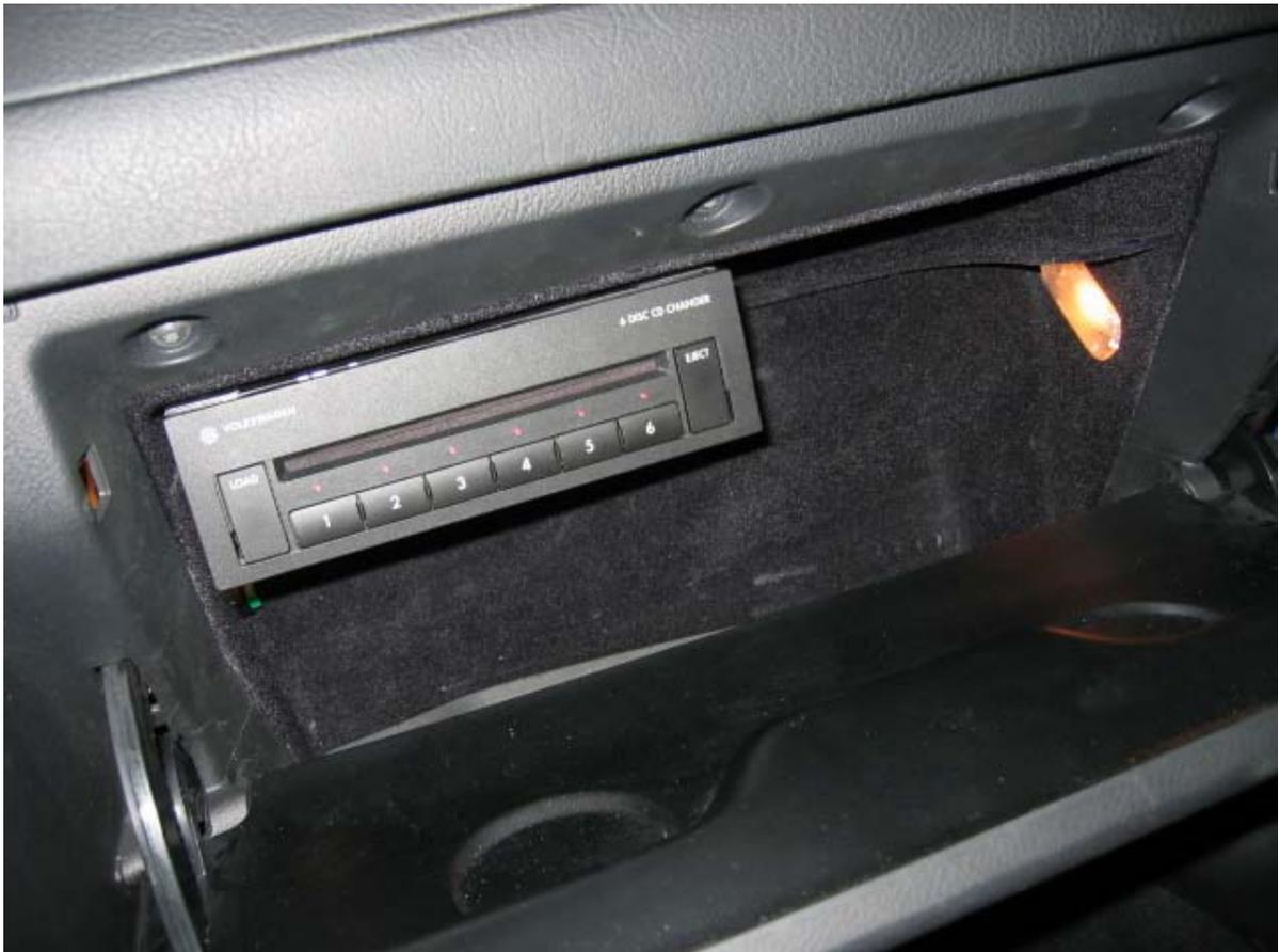
Y aquí todo montado. Arriba el cargador, debajo el interface multimedia y pegado a el la luz de cortesía, y el botón para suprimir la señal Gala.
