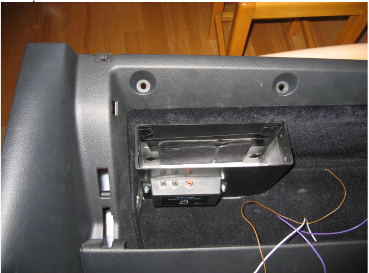
Lleva algo de cinta americana negra para evitar que roce en los tornillos que sujetan a toda la estructura al techo, tornillos de 4mm con tuerca autoblocante.
