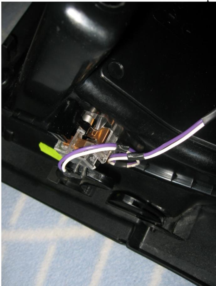
Guantera vista por detrás, los cables son de alimentación del interface y de señal de datos del mismo. El que va de un lado al otro es el de la luz de cortesía.
