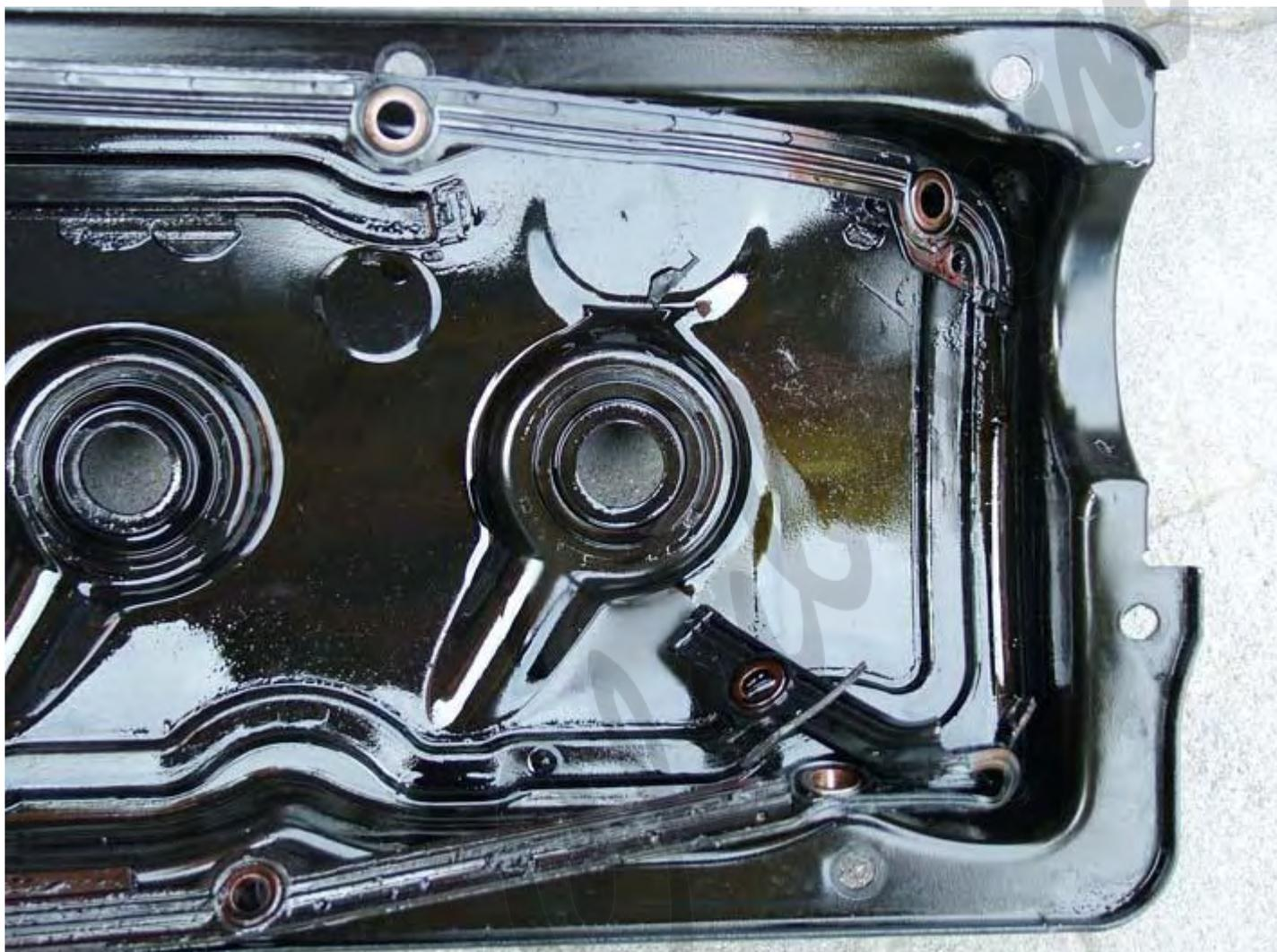
Al poner esa tapa, debió de engancharse (es complicado ponerla sin esfuerzo), con el ultimo inyector, despegándose un poco y quedando des posicionada, con lo que al apretar los tornillos de la tapa de la culata la partió, quedando un buen trozo sin junta, y con las presiones que se trabaja en esas culatas...
