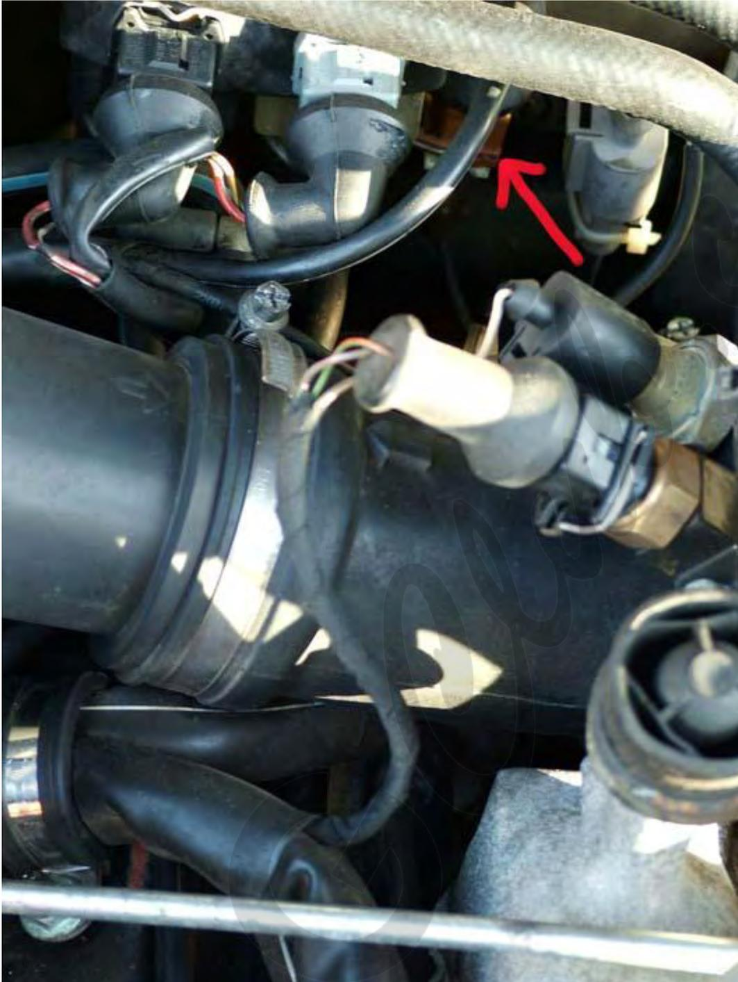
En la parte derecha, bastara básicamente con desmontar el colector de admisión del aire desde el intercooler a las bancadas
