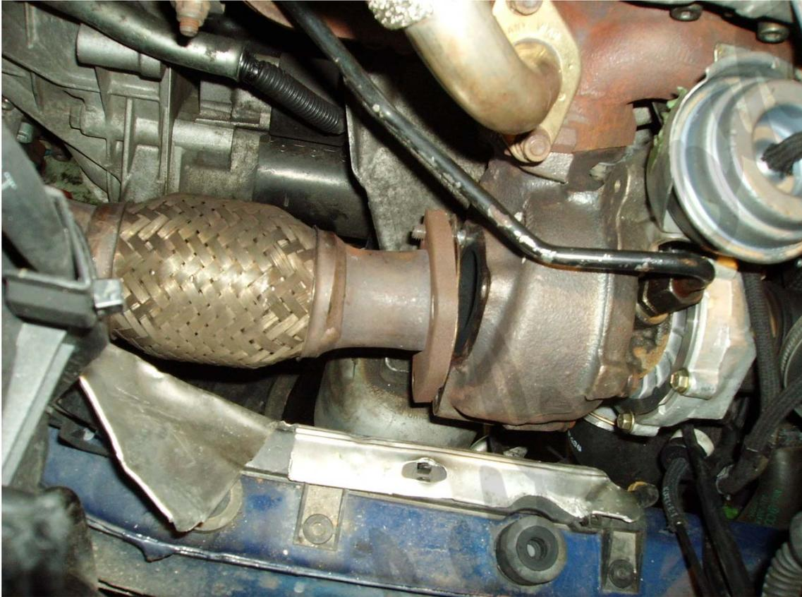
Se afloja la junta de unión entre el escape intermedio y el catalizador para poder sacar el tubo del catalizador.
