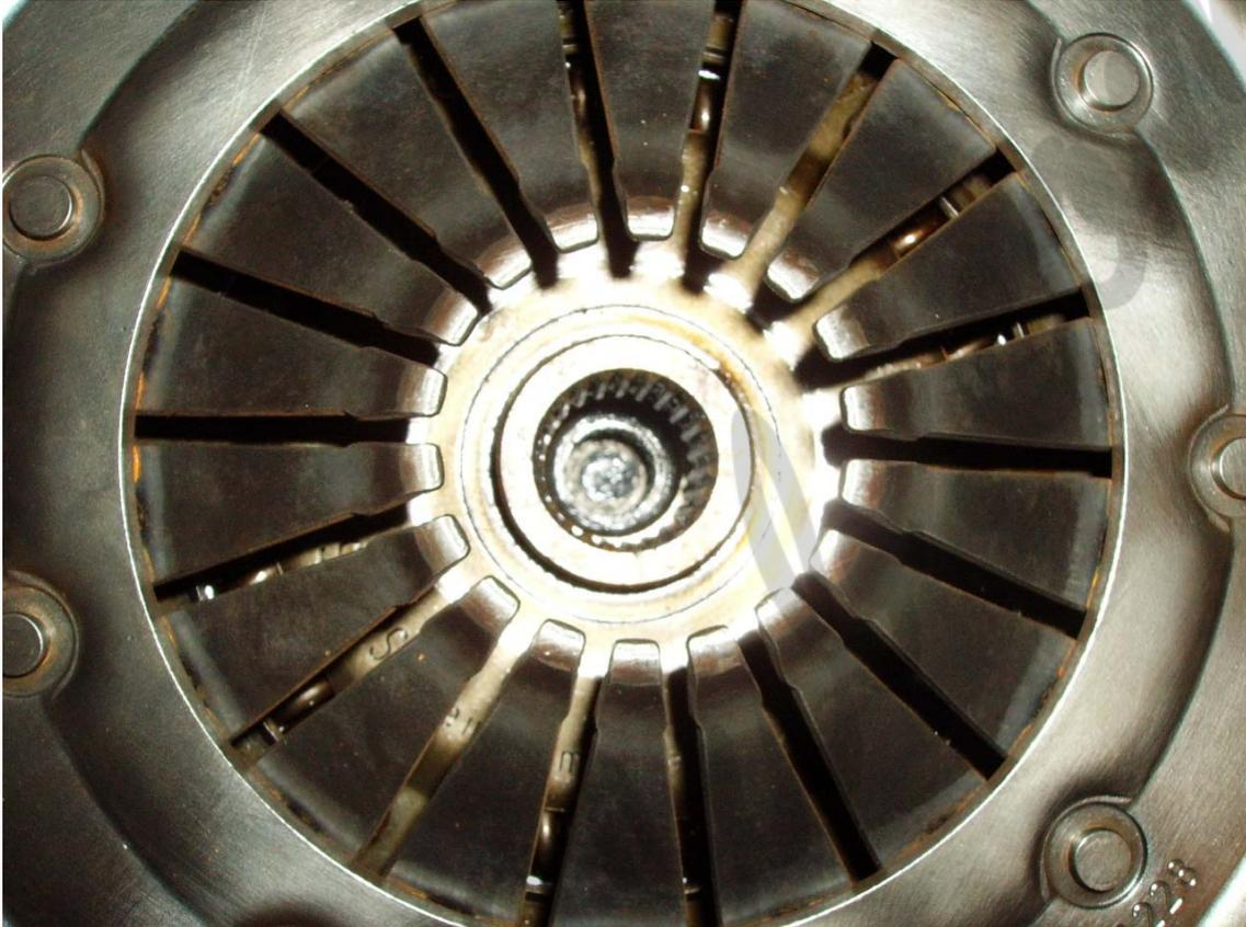
Se colocan los tornillos y se aprietan poco a poco con un cuarto de vuelta para no doblar la maza del embrague, hay que fijarse que el disco del embrague queda centrado. Estos tornillos hay que apretarlos con una llave dinamométrica, hay que mirar cuanto apriete tiene para cada modelo ya que puede variar.
