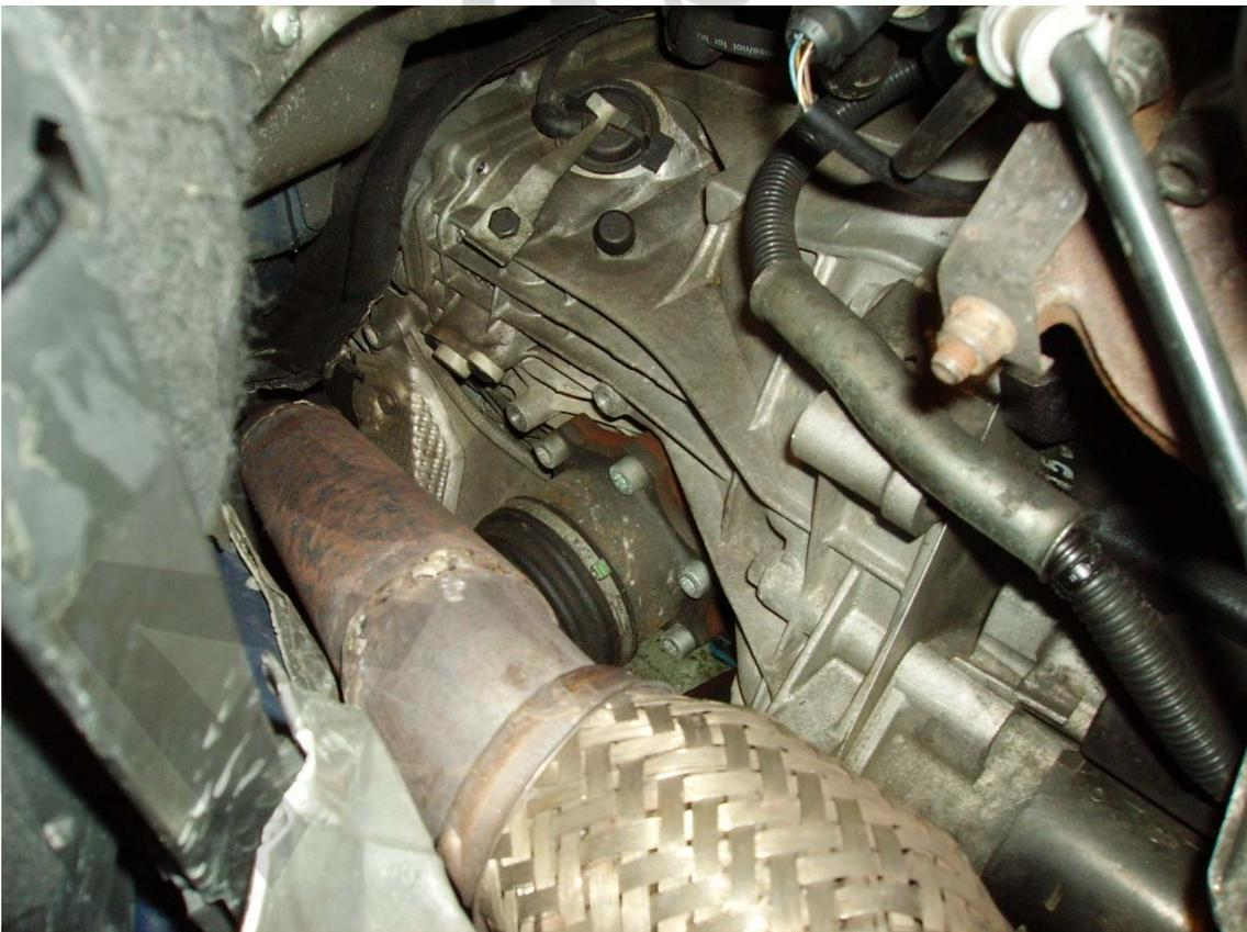
Se retiran los 3 tornillos de la chapa de aluminio que cubre el soporte del motor.
