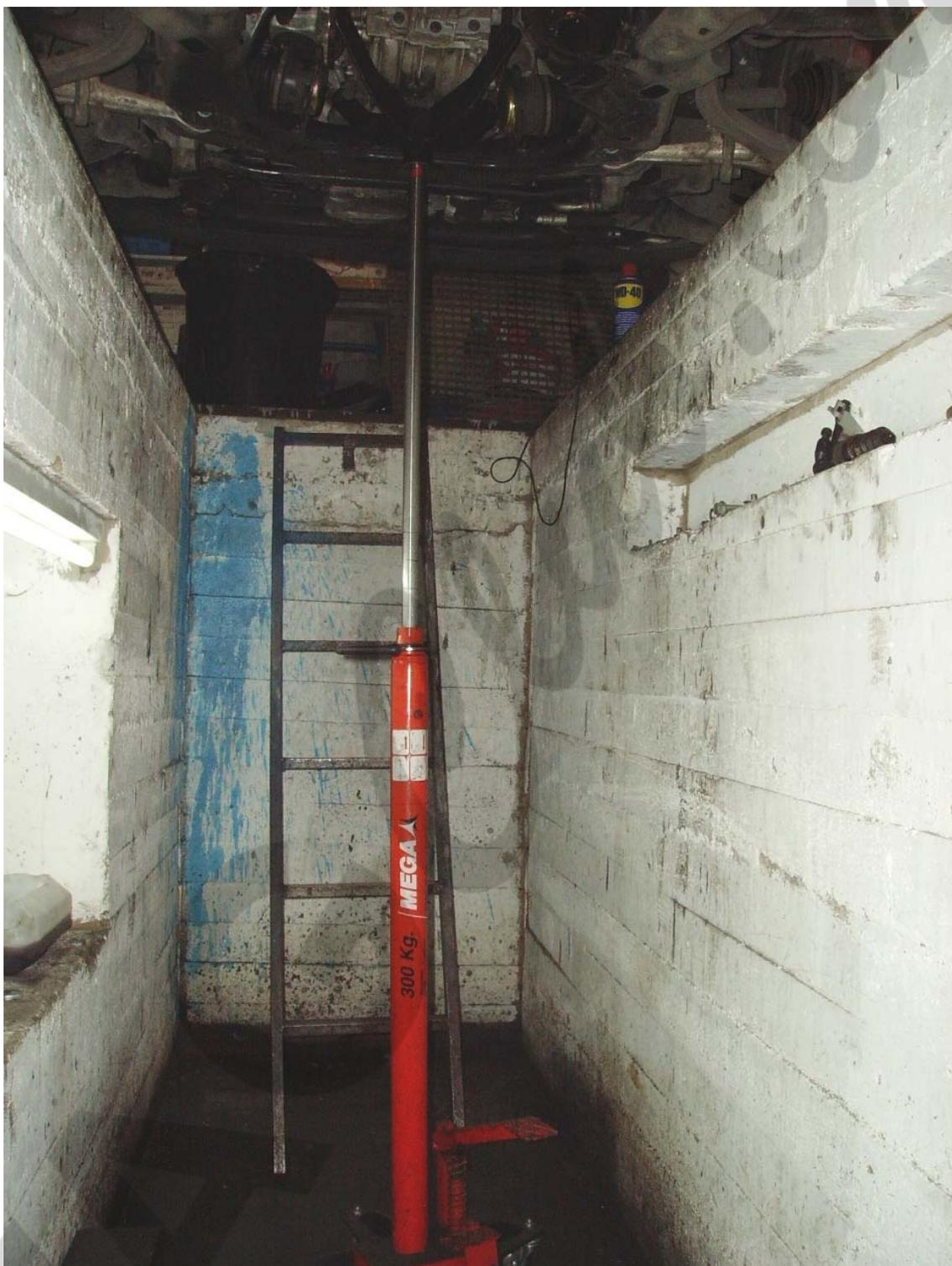
Se sacan los 3 tornillos del taco motor de la parte delantera para poder sacar los tornillos que hay por abajo del cambio. Una vez sacados se vuelve a colocar para que no nos descuelgue el motor.
