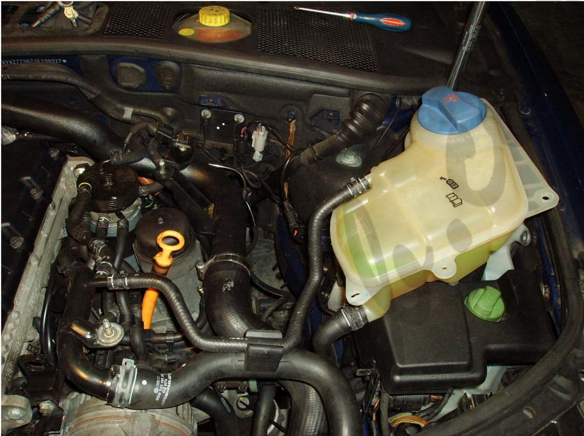
Se retira el tubo de plástico que lleva el aire del intercooler al colector de admisión.
