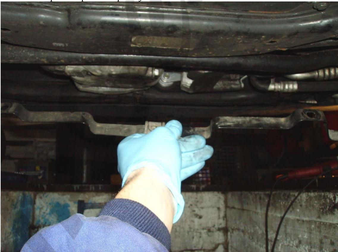
Se afloja ese tornillo, se retirará al final después de sacar todos los demás tornillos.
