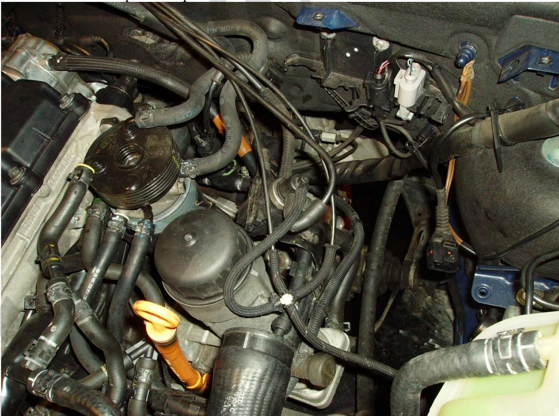
Se saca el tubo de liquido de frenos en el bombín del embrague, para ello se saca el pasador (alambre) y luego se tira del tubo (hay que tener a mano algún tapón para tapan el tubo para que no caiga el liquido), luego se saca el tornillo de allen de 5 para sacar el bombín para fuera.
