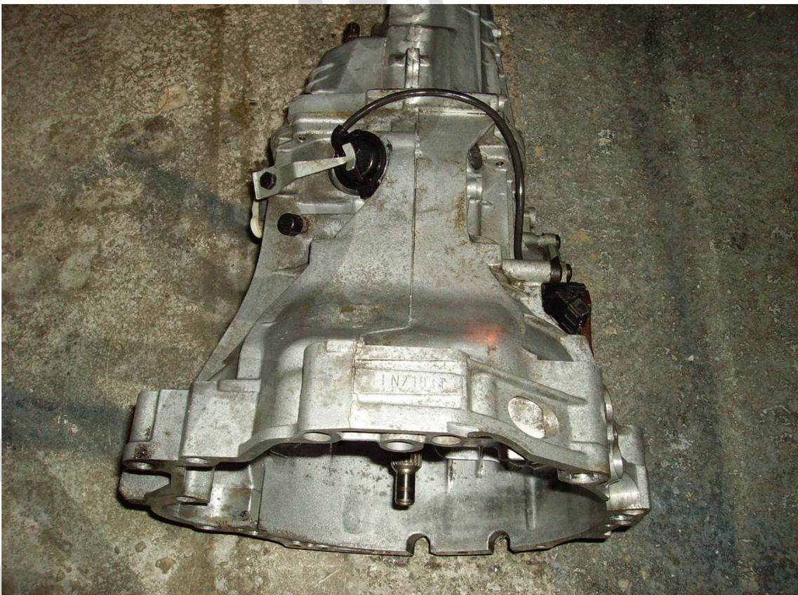
En la parte alta del cambio se puede ver el modelo de cambio que tengo, es un EEN.
