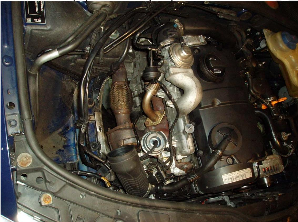
Se sacan los 3 tornillos que sujetan el escape del turbo.
