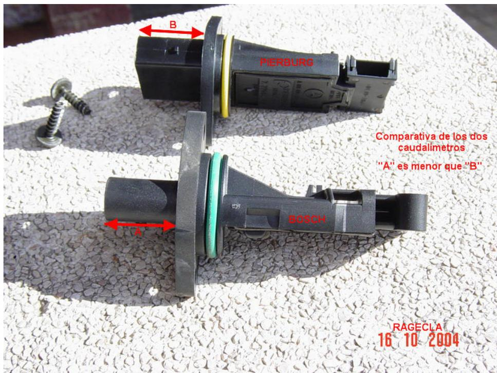
Ya podemos quitar los tornillos torx, pero ojo que se necesita una torx inviolable o antiviolante. No es más que una punta torx que dispone de un agujero en medio. Se quita los dos tornillos y se saca el caudalimetro. En la imagen superior se puede ver los dos caudalímetros. La forma y las dimensiones donde se encajan y donde se ponen los tornillos son idénticas. Existen
