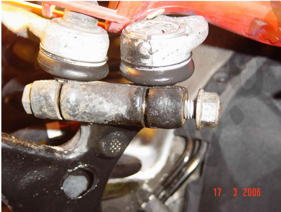
El siguiente es aflojar los dos tornillos de la rotula de la dirección, así como empleando una llave del 22 y otra del 18 aflojar la contratuerca de la rotula de la dirección, ojo volver a ponerla apretando con la mano. Seguimos por las tuercas del la orquilla del amortiguador y la de los brazos inferiores que los unen a la mangueta. Y por último los que sujetan a brazos que une a la barra estabilizadora. Las fotos muestran cada una de las tuercas.
