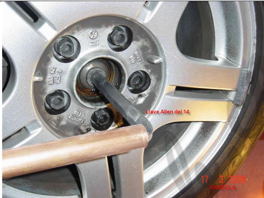
Para aflojar el tornillo central debemos ayudarnos de una barra para poder realizar una buena palanca, pues el tornillo esta bastante apretado. Siempre es recomendable aplicar algún aceite afloja tornillos. Para evitar que el tornillo se deforme y redondee, conviene con ayuda de un partillo de introducir bien la llave allen. Solo se afloja un poco y con la rueda en el suelo. En algunos modelos es un tornillo con cabeza hexagonal no allen.
