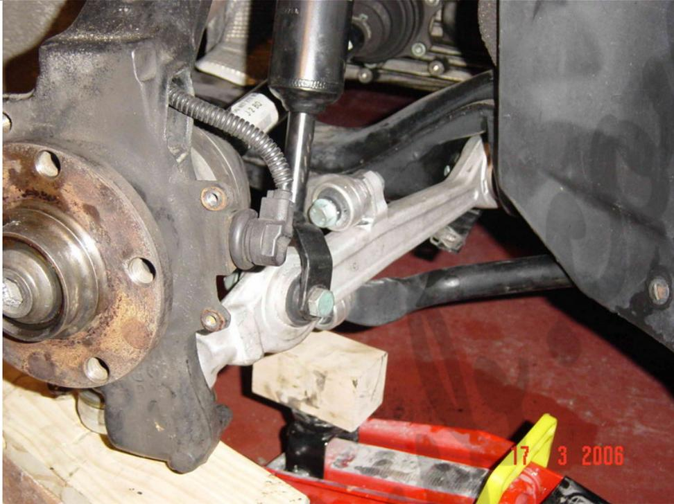
Una vez metido los brazos superiores, se sujetan con el tornillo pasante y se atornilla la tuerca.
