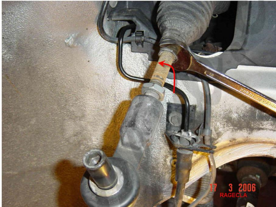
Se puede hacer una prueba y es emplear un calibre y medir la cota desde la tuerca y la rotula de la dirección. La foto muestra la prueba. Cuidado que esta en inch.
