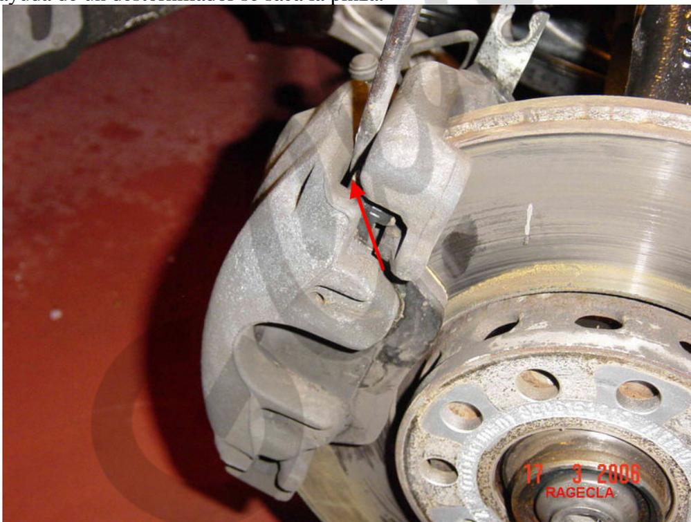
Ya tenemos la pinza del freno en la mano. Se pueden ver aquí las dos pastillas del freno. Se debe atar la pinza con un alambre y dejar sujeta en algún sitio para que no nos moleste.
