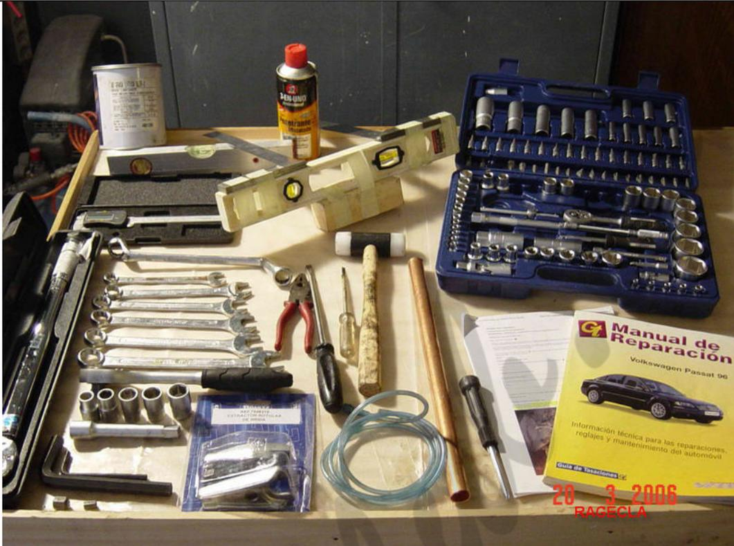
Esto es todo el material necesario para el cambio. Nada que no se pueda tener en el taller. Mencionar que las medidas de los vasos o llaves necesarias son 13, 16, 17, 18 y 22. Normalmente la 16 y 18 no suelen estar incluidas en los set de llaves fijas. Y se necesita dos del 18 para gran parte del trabajo.
