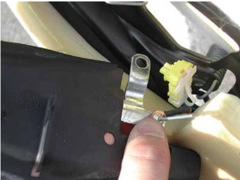
Luego conectamos la clema amarilla (apretar muy fuerte y aseguraos de que ha entrado completamente que si no luego os dará fallo de airbag y os tocará desmontarlo entero otra vez y ponemos los tornillos de sujeción.
