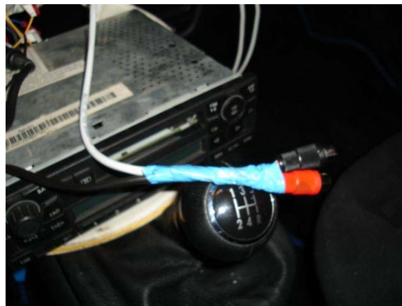
Puenteado de la manguera del cargador con nuestra manguera del jack hembra auxiliar
