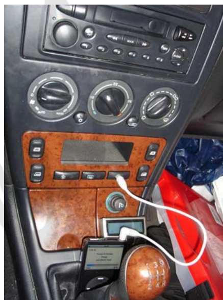
Puenteado de la manguera del cargador con nuestra manguera del jack hembra auxiliar en un “no vag”
