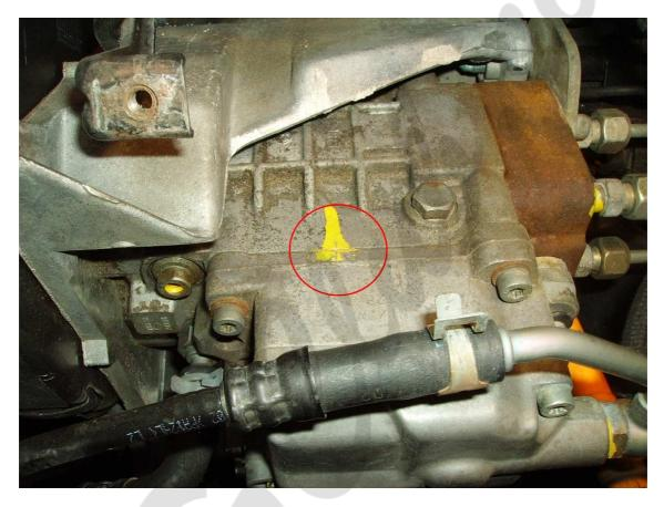
En la siguiente foto se ve los 4 tornillos a aflojar, repito, aflojar no sacar. Con el motor a ralenti y caliente a temperatura de 90° se aflojan y se vuelve a apretar pero sin que ejerza mucha presión ya que nos tiene que permitir mover la parte alta de la bomba. La bomba tiene dentro e 2 a 5 kg de presión aproximadamente, de ahí que no se puedan dejar flojos porque escaparía el gasoil y podría apagarse el coche.
