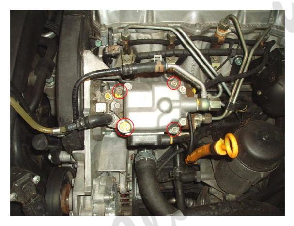
El tornillo inferior izquierdo tiene una forma rara con lo que necesitamos un útil especial para aflojarlo. En <a href="www.vagclub.com">www.vagclub.com</a> próximamente se podra adquirir el que lo quiera.
