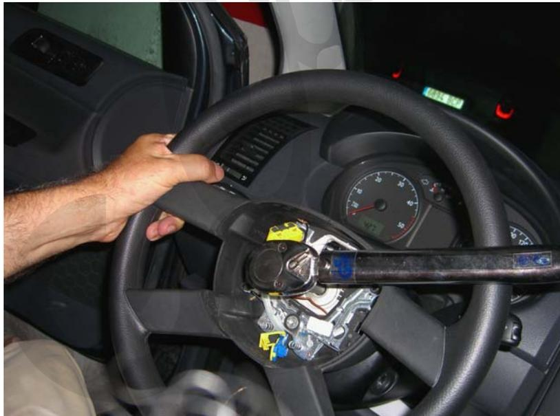
Hay que marcar con un puntero el tornillo del volante, se supone que el tornillo no debe apretarse más de 5 veces.
