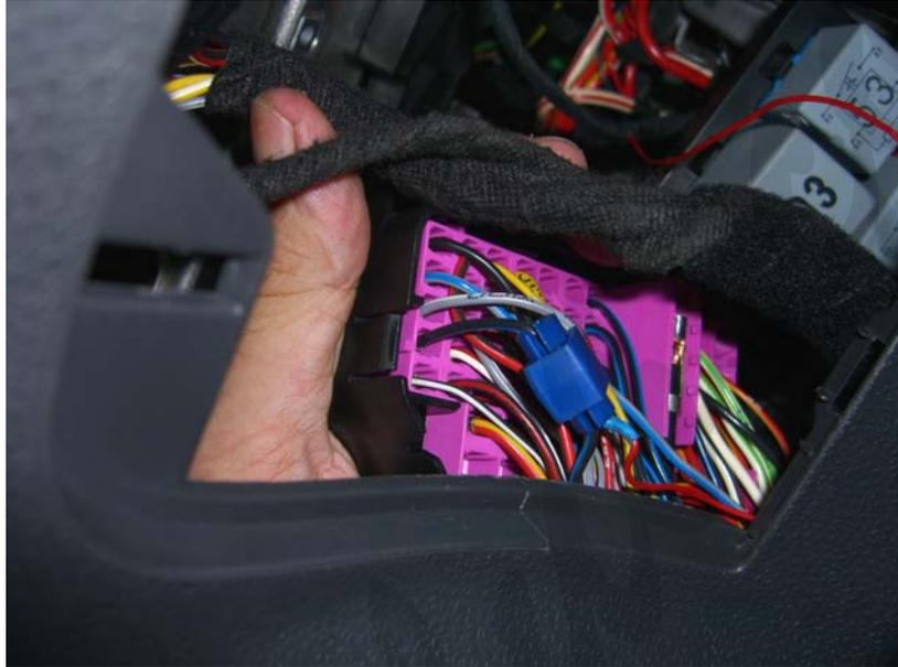
Fijamos con abrazaderas el mazo de cables bajo la columna de dirección y creamos la caja de fusibles colocándola en su lugar.
