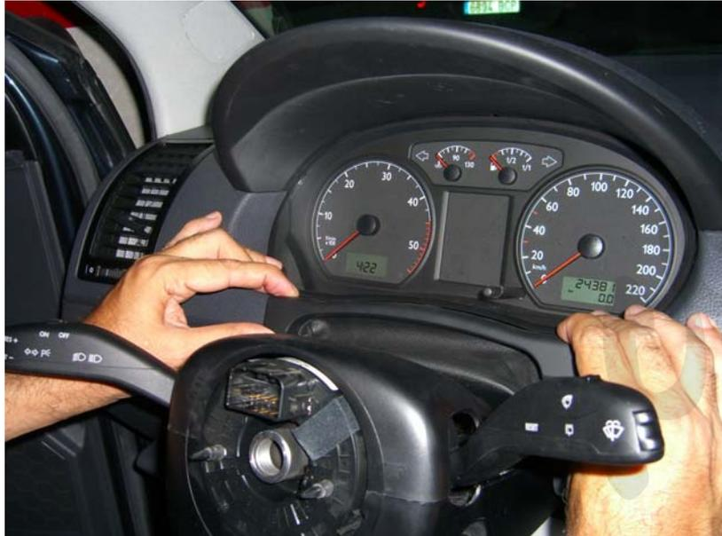
No olvidemos poner un trozo de cinta aislante para fijar el posicionador del volante y evitar que pueda girar en ningún sentido.
