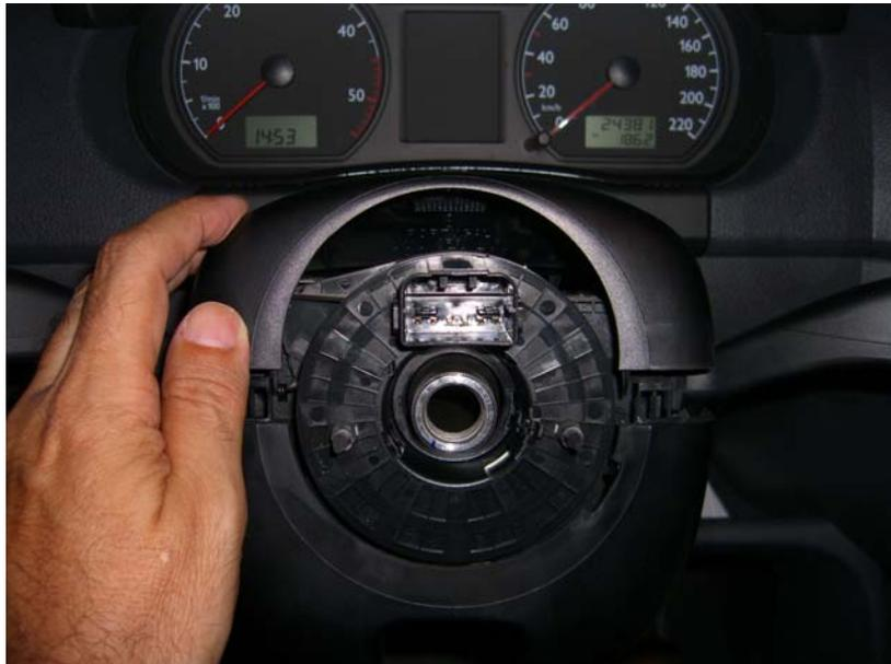
Para sacar la mitad inferior hay que quitar tres tornillos, dos arriba y uno junto a la palanca de enclave de la dirección.
