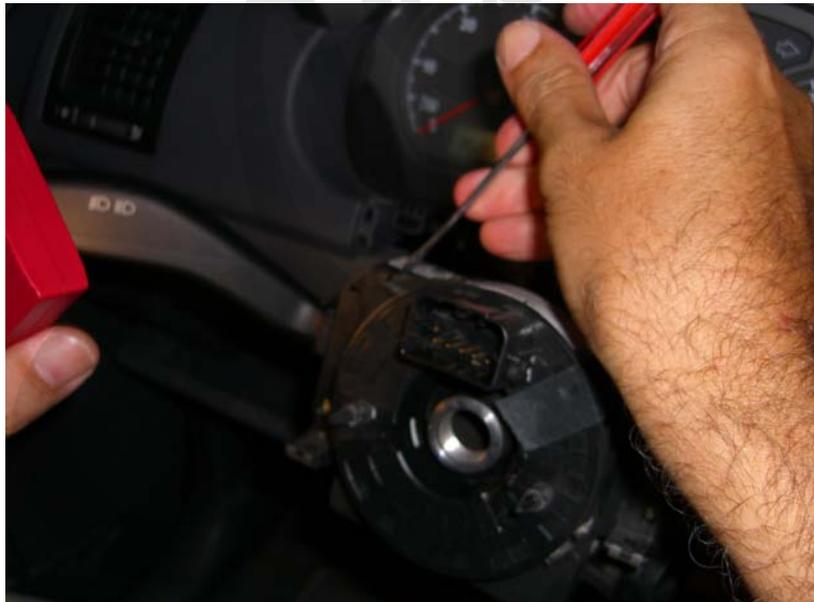
Soltamos las palancas aflojando el tornillo con la llave allen.
