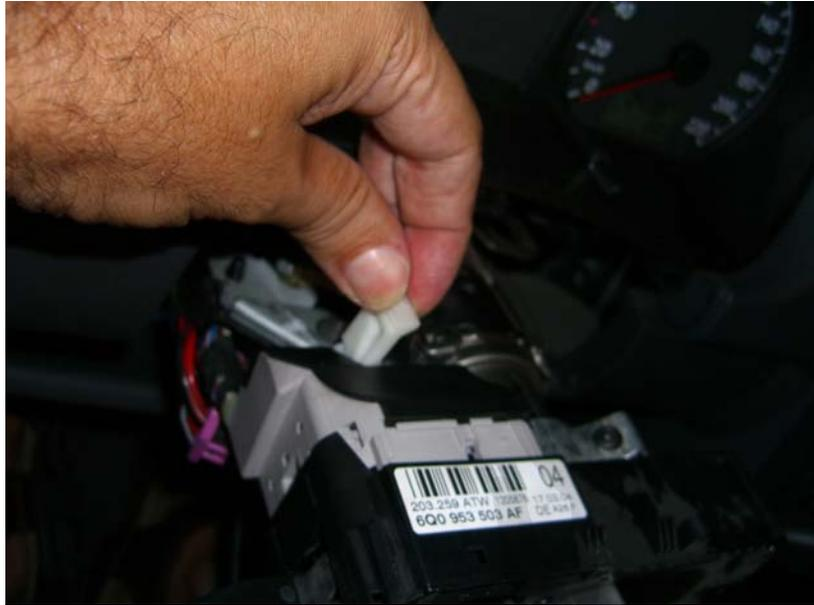
Una vez extraído cortamos la abrazadera que asegura los cables en el conector.
