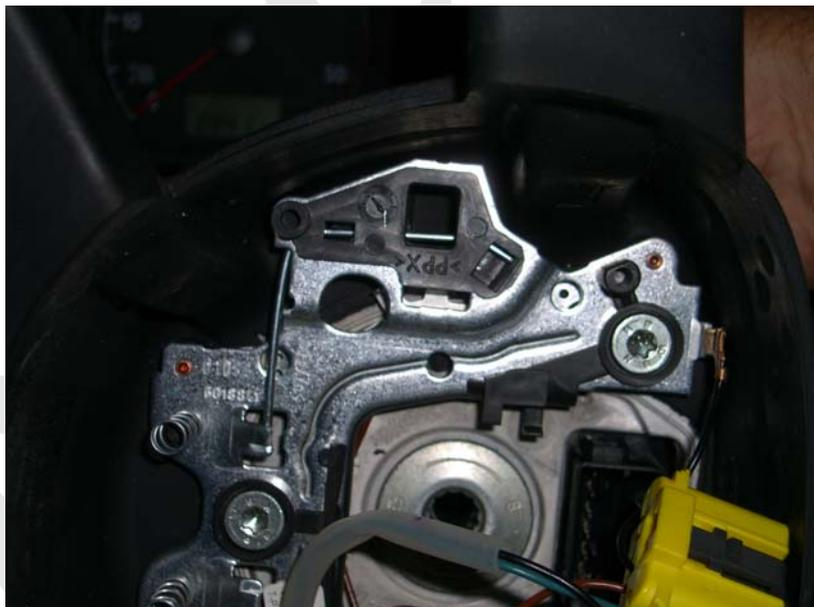
Y en posición liberado, se ve en la ventana pequeña la punta del destornillador presionando el muelle.
