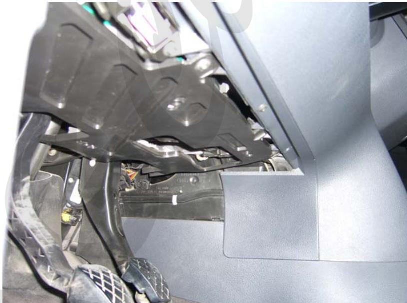
Separamos el clip de la caja de con rol de conexiones y tiramos de ella hacia abajo separándola de su posición
