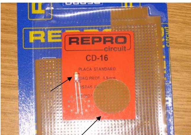
Para las luces se recorta un círculo de circuito impreso de 28mm de diámetro, la placa tiene que ser de pistas paralelas y se han de conectar los negativos de los diodos en común y los positivos con una resistencia de 560 ohmios y se hace un nuevo común en este caso para los positivos.
