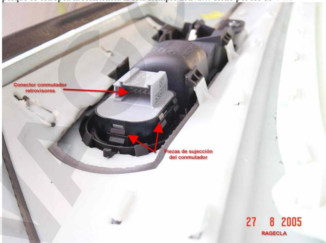
Como se ve el conmutador va sujeto a la pieza del tirador del coche por unas topes de plástico. Se hace palanca y se tira a la vez del conmutador (pieza gris clara). Se suelta de los dos lados y ya tenemos el conmutador fuera. Se pone el nuevo de la misma forma y a montar el panel de nuevo en el coche.
