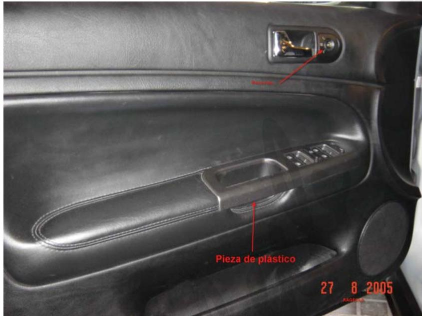
Con cuidado para no marcar nada se debe meter la punta fina de un destornillador y hacer fuerza hacia la puerta, para quitar la pieza de plástico que esta debajo del agarradero de la puerta.
