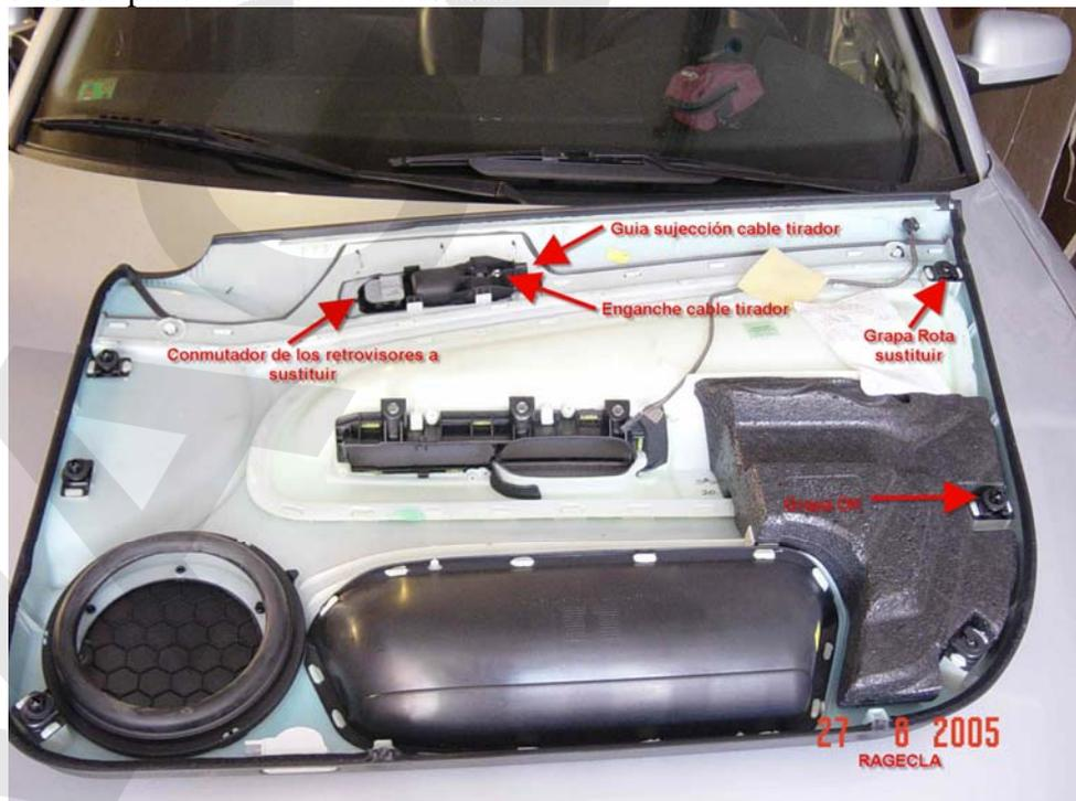
Un detalle interesante para la hora del montaje. El cable para abrir la puerta tiene que ir enganchado en la agujero y conducido el cable sobre el soporte de plástico, ver la foto.
