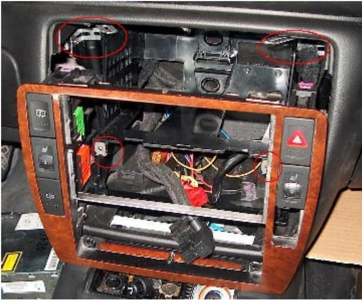
Estas grapas sirven para sujetarlo en los tirantes que hemos colocado arriba. Cuidado al introducirlo que los tirantes queden por debajo de las grapas del embellecedor. Lo sujetamos con los tornillos superiores y ponemos las grapas debajo, donde se atornillara el clima.
