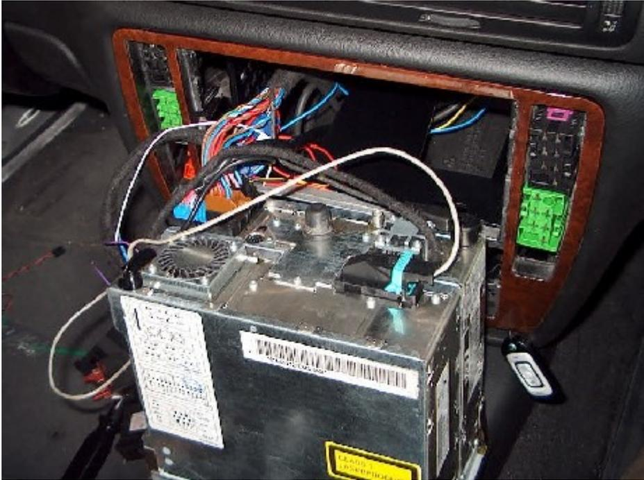
Una vez hechas todas las conexiones (Antenas, T26 y los dos ISO) introducimos el navi a la vez que tiramos de los cables desde el hueco inferior para que no queden pillados en el fondo del soporte.
