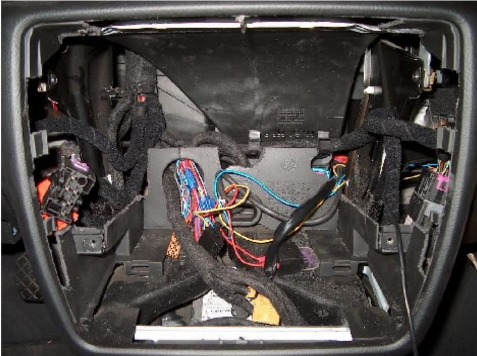
Una vez hecho el hueco, es conveniente colocar unos soportes que aseguren el marco y el embellecedor, os cortaremos de una pletina perforada similar a las de mecano. Y a partir de ahí las cortamos y doblamos.
